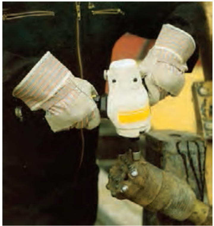
شکل ۸-۱۳- نحوه تیز کردن دکمه‌های سر مته
