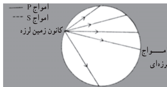
شکل ۱-۶- عبور امواج زلزله در ساختار یک‌نواخت
