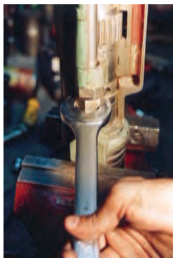
شکل ۲۲-۴- نحوه‌ی جازدن میله پیچ و مهره و بستن مهره‌ی آن
