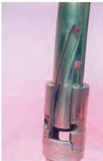
شکل ۲-۴- نحوه‌ی کار پرفوراتور
