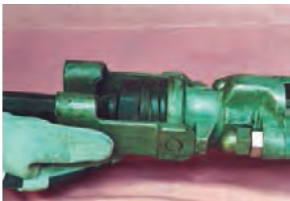
شکل ۲۵-۴- نحوه‌ی تعویض و جازدن مته
