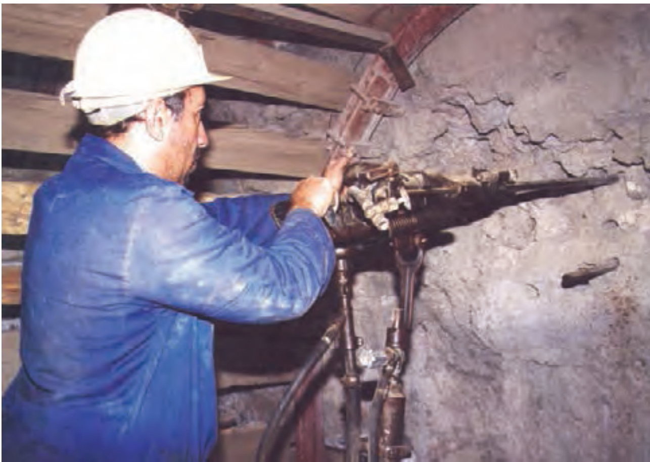
شکل ۲۷-۲- نحوه‌ی به‌کارگیری پرفوراتور
