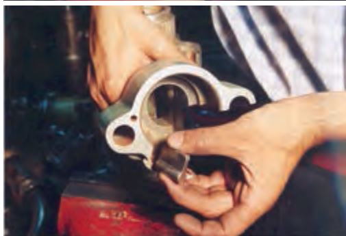
شکل ۱۶-۴- نحوه‌ی جازدن پاول و فنر و ساچمه
