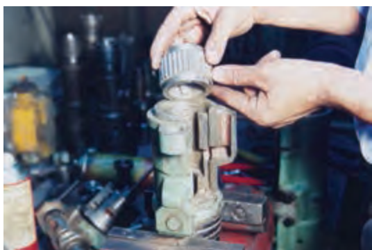
شکل ۱۷-۴- نحوه‌ی جازدن جفجغه
