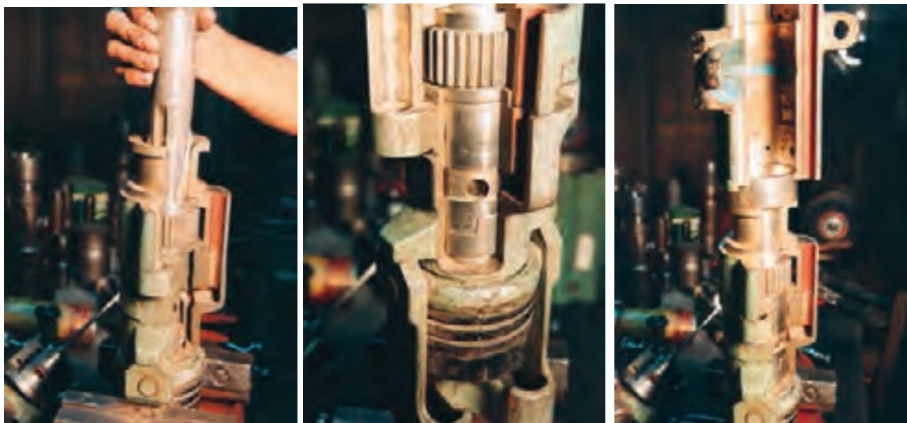
شکل ۱۸-۴- نحوه‌ی جازدن پیستون و پوسته آن
