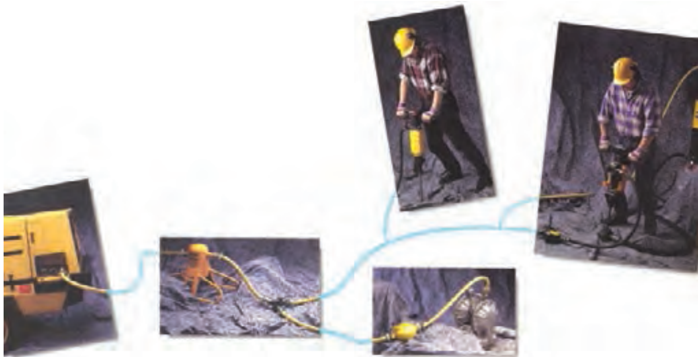
شکل ۵۲-۳- اتصال انواع مصرف‌کننده به کمپرسور
