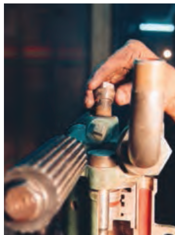
شکل ۲۳-۴- نحوه‌ی جازدن پوشش آب‌بندی و واشر آب‌بندی
