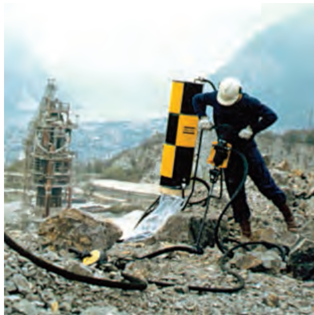
شکل ۱۲-۴- تصاویر کنترل کننده گردوغبار به صورت خشک (فیلترهای جداکننده گردوغبار)
