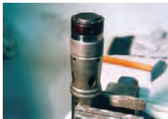
شکل ۲۳-۳- مراحل جازدن در پوش سوپاپ
