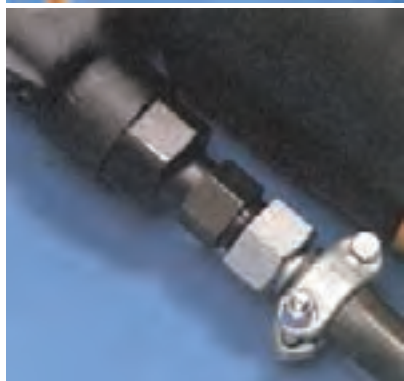
شکل ۳-۴۳- نحوه‌ی بستن پیچ و مهره بست شیلنگ
