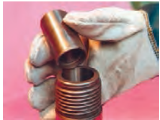
شکل ۱۶-۳- نحوه ی جازدن بوشن قلم گیر پیکور
