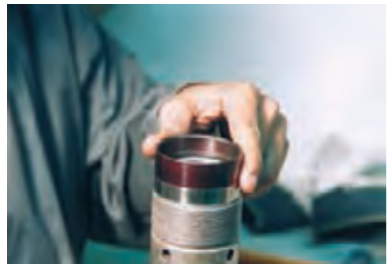
شکل ۳-۲۱- نحوه‌ی جا زدن پوسته‌ی سوپاپ
