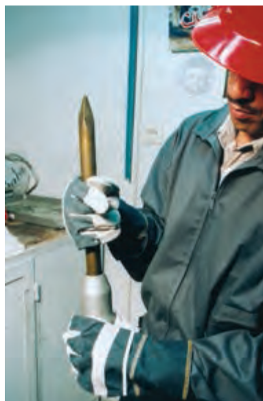
شکل ۲۵-۳- چگونه‌ی جازدن لاستیک ضربه گیر و عبور دادن قلم از سریک
