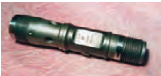
شکل ۱۴-۳- نمای ظاهری سیلندر در دستگاه پیکور
