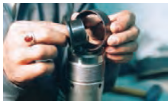
شکل ۳-۲۰- تصویر پوسته‌ی سوپاپ و سوپاپ یا کشویی
