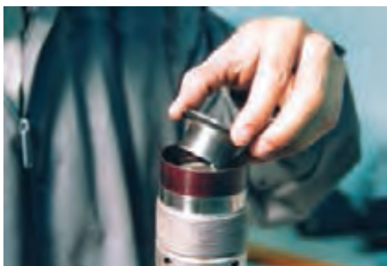
شکل ۳-۲۲- نحوه‌ی جا زدن سوپاپ
