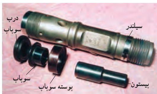
شکل ۱۴-۳- نمای ظاهری سیلندر در دستگاه پیکور
