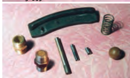
شکل ۹-۳- اجزای مختلف دسته یا سرسیلندر پیکور
