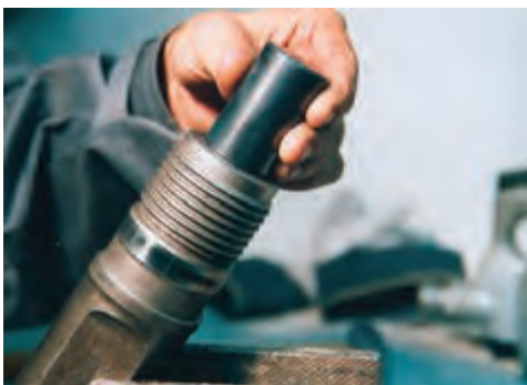
شکل ۱۸-۳- نحوه ی جازدن بیستون
