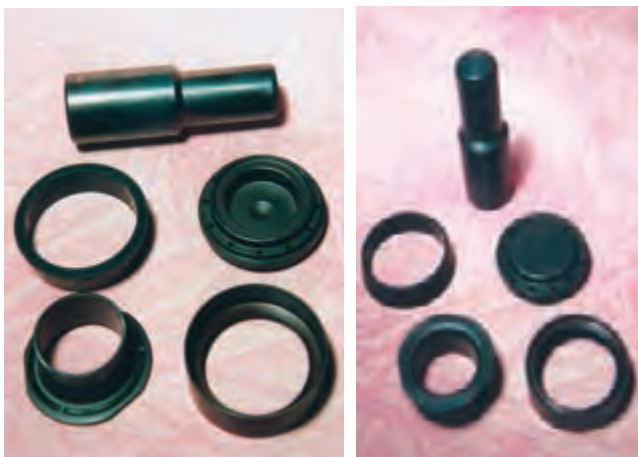
شکل ۱۵-۳- متعلقات و اجزای سیلندر پیکور
