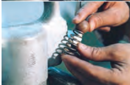
شکل ۱۰-۳- نحوه‌ی جا زدن ساچمه و فنر
