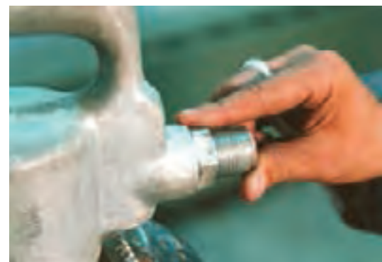
شکل ۱۱-۳- نحوه‌ی جا زدن فنر و ساچمه و بستن بوشن صافی‌دار
