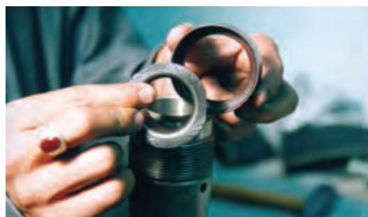
شکل ۳-۲۰- تصویر پوسته‌ی سوپاپ و سوپاپ یا کشویی
