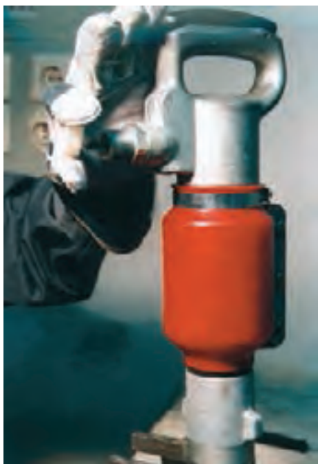
شکل ۲۹-۳- نحوه‌ی جاذدن درپوش جلوگیری از ورود گرد و غبار به دستگاه
