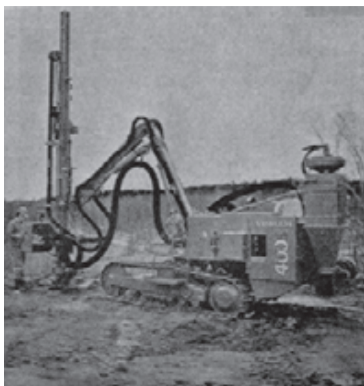
ج - واگن دریل 400S ساخت تامراک با بازوی تاشو در حال حفر چال قائم
