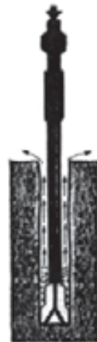
شکل ۸-۲- خارج شدن خرده‌ریزه حفاری از فضای بین میله مته و چال
