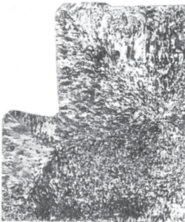
شکل ۲-۳- شمش آلومینیوم بزرگ‌نمایی \times 1 محلول اچ‌تاکر
