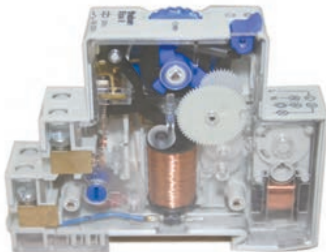
شکل ۵-۲۳- شمایی از یک رله‌ی زمانی
