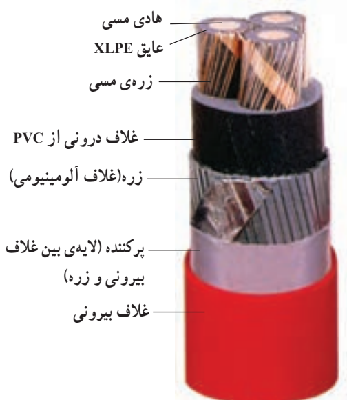
شکل ۳۹-۴ کابل با غلاف آلومینیومی
