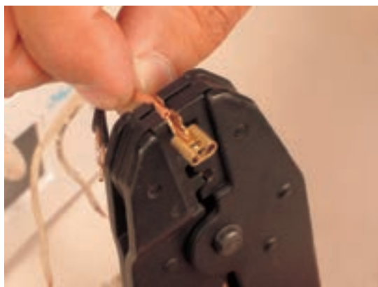
شکل ۳-۲۳ - نحوه‌ی پرس کردن سرسیم
