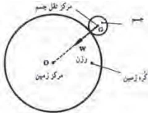
شکل ۱-۶- اثر میدان جاذبه زمین بر یک جسم (وزن)
