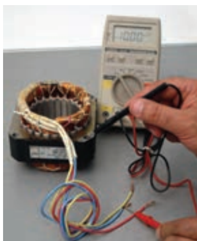
شکل ۲-۱۵- تست اتصال بدنه
