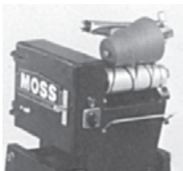
شکل ۱-۳- حرکت بوبین روی درام
