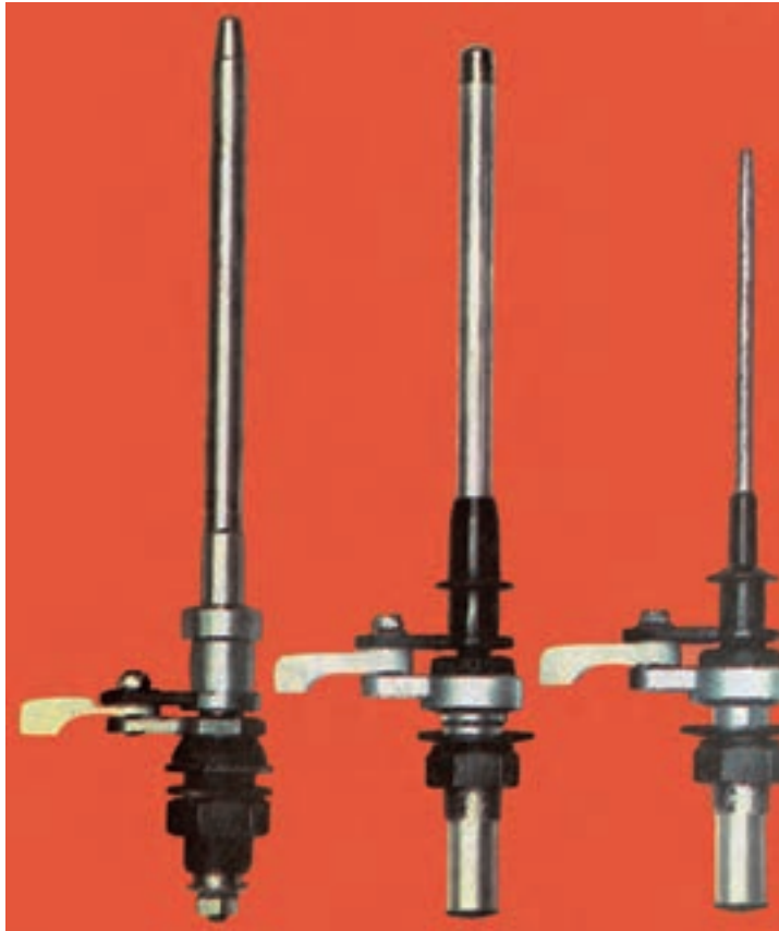
شکل ۱۷-۷. انواع دوک‌های ماشین تمام‌تاب
