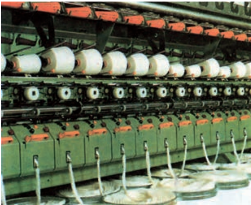
شکل ۱-۸- ماشین ریسندگی سیستم چرخانه‌ای
