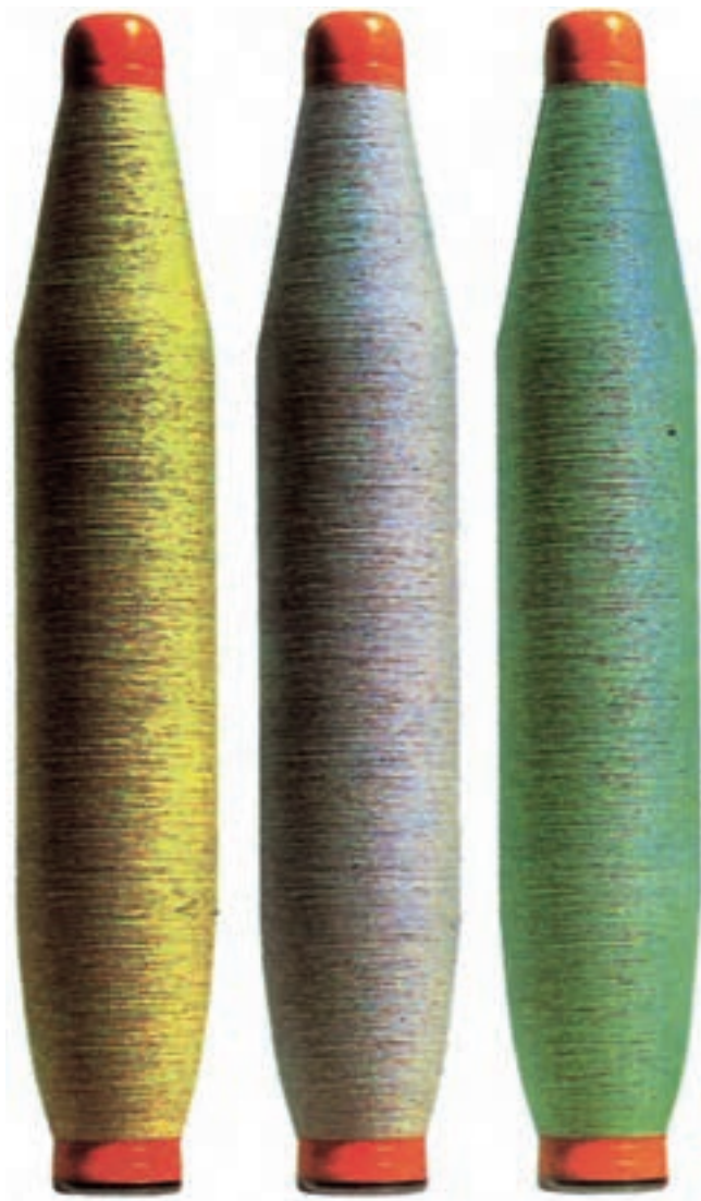
شکل ۷-۲۰- تصویری از قرقره‌های پرشده در ماشین تمام تاب
