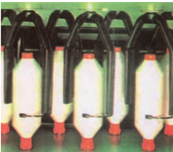
شکل ۶-۷- تصویری از پروانه و بوبین در ماشین نیم تاب
