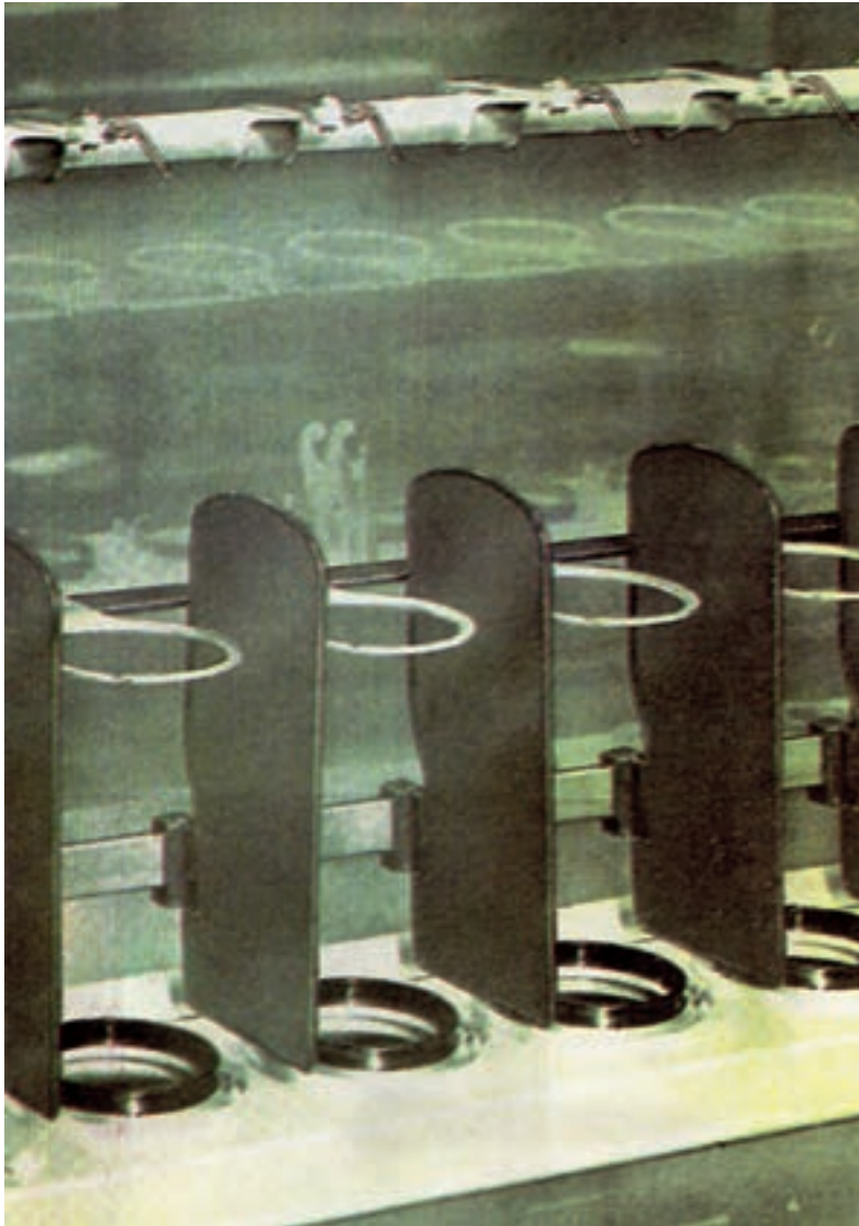
شکل ۲۷-۷- صفحات جداکننده در ماشین تمام تاب
