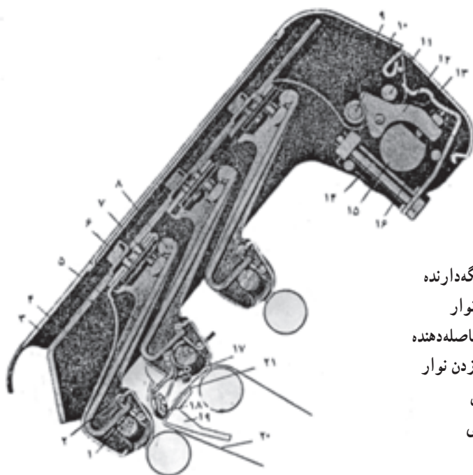
شکل ۷-۹- نمای برش بازوی فشاردهنده
