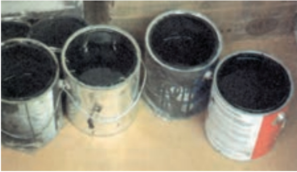
شکل ۱۸-۱- برای جلوگیری از نشت رنگ، باقی مانده‌ی آن در ظروف باید خشک شود و سپس به طریق صحیح دفع گردد.
