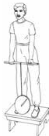
شکل ۵-۲ - دینامومتر برای اندازه‌گیری قدرت ایستا
