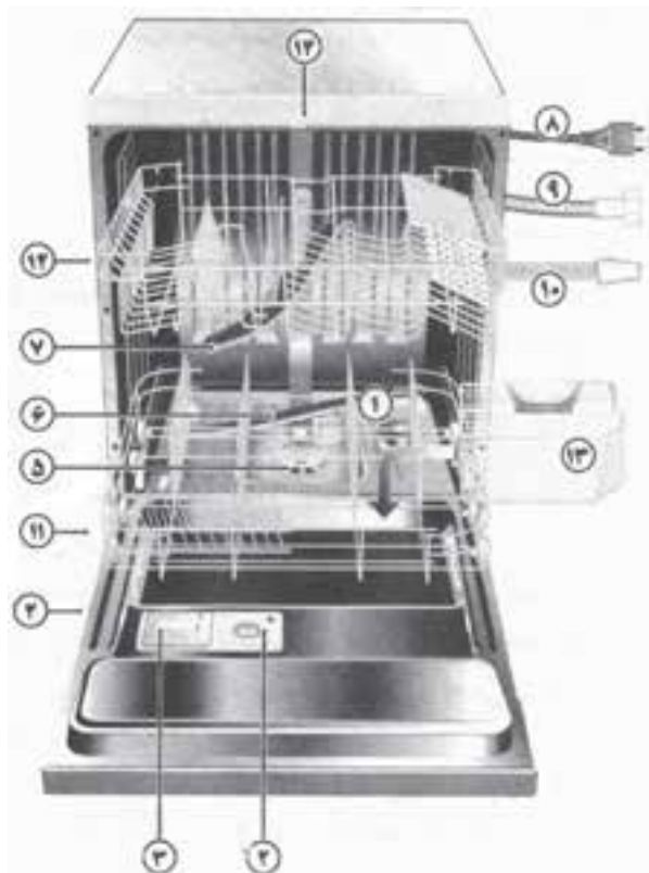
شکل ۱۶-۶- اجزای ماشین ظرفشویی اتوماتیک
