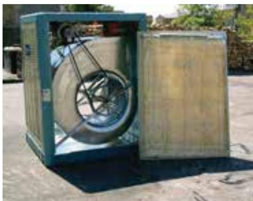
شکل ۱۳-۱۱- ساختمان اتاقک یک کولر
