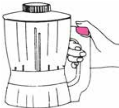
شکل ۷-۱۶- طریقه عملکرد دستگاه با فشار دکمه شستی
