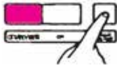
شکل ۹-۷- آماده به کار نمودن قطع کننده مدار (RESET)
