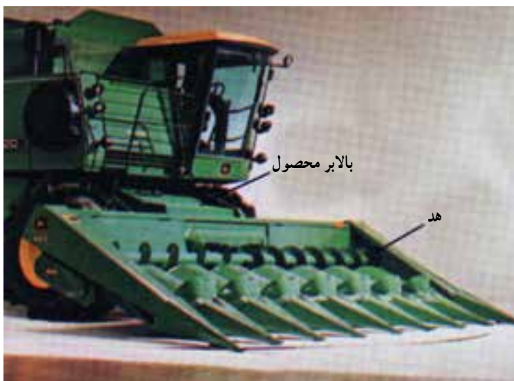
شکل ۳۲-۴- یک کمباین متداول مجهز به یک دماغه ذرت شش ردیفه
