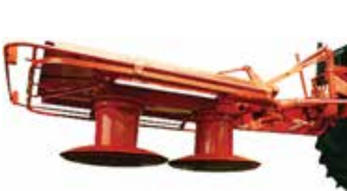
شکل ۹-۴- تراز عرضی دروگر استوانه‌ای
