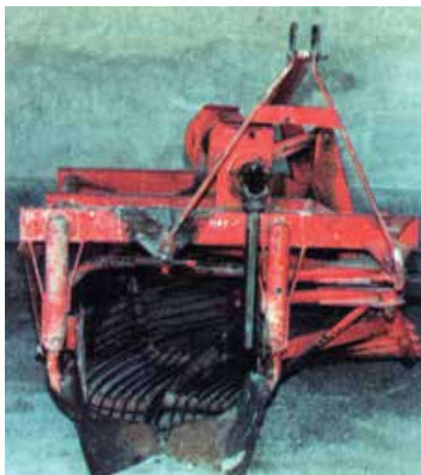
شکل ۲۱-۴- ماشین برداشت سیبزمینی با صفحه مشبک لوزان
