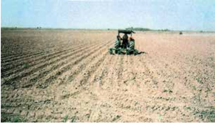
شکل ۱۳-۲ - دستگاه ردیف‌کار ذرت در حال کاشت ردیفی
