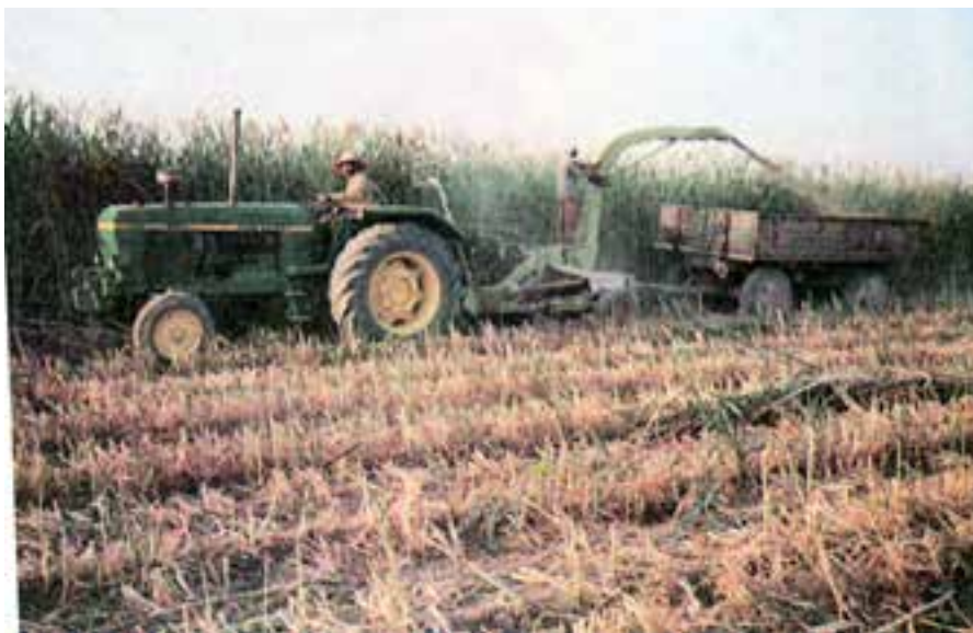
شکل ۱۹-۲- عملیات برداشت ذرت علوفه‌ای با چاپر
