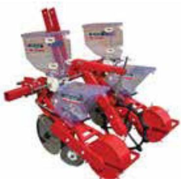
شکل ۹-۴- بذرکار دو ردیفه تراکتوری مجهز به کودکار
