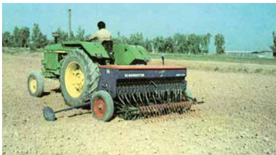
شکل ۱-۲- بذرکار خطی کار در حال کاشت گندم
