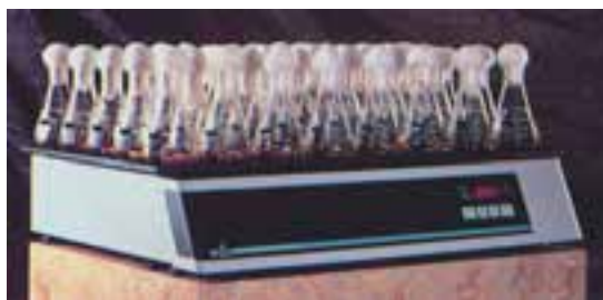
شکل ۶-۱- تکان‌دهنده مخصوص ارلن
