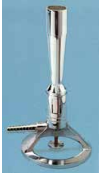
شکل ۱۷-۱- یک نمونه از چراغ گازی آزمایشگاه
