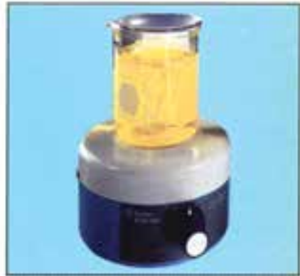
شکل ۷-۱- دو نوع همزن مغناطیسی
