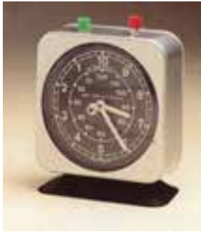
شکل ۱۸-۱- دو نمونه کروномتر
