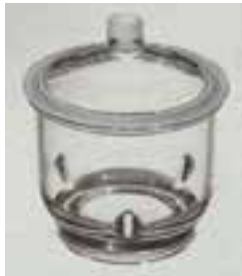
شکل ۱۹-۱- دو نمونه دسیکاتور
