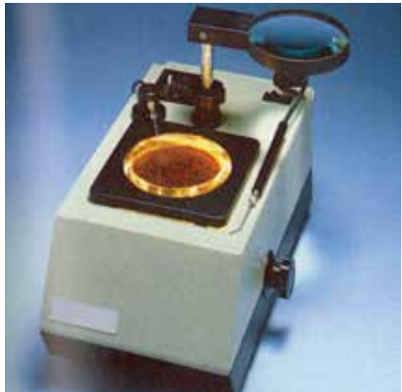
شکل ۱-۳- دو نوع پرگنه شمار
