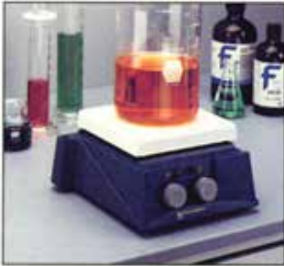
شکل ۷-۱- دو نوع همزن مغناطیسی
