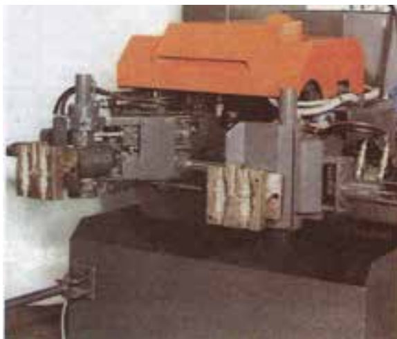
شکل ۳-۲۴— ماشین ریخته‌گری ریزه تمام اتوماتیک
