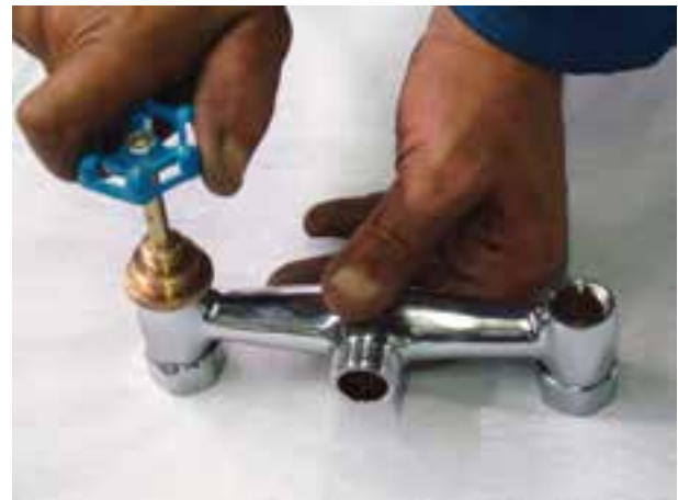
ج- عمل کف تراشی شیر
