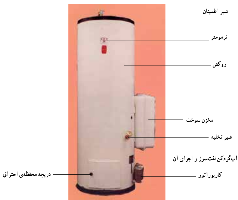
شکل ۱-۱۳- اجزای آب گرم کن نفت سوز
