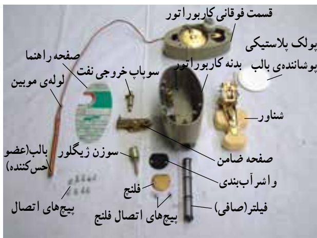
شکل ۷-۱۳- اجزاء باز شده‌ی کاربوراتور آب‌گرم‌کن مخزنی نفت سوز
