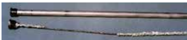
ب - یک نوع میله‌ی آند قبل از نصب و آند استفاده شده
