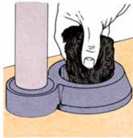
شکل ۵۲-۱۰- رسوب‌زدایی نشیمنگاه زیراب
