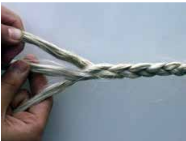
شکل ۲-۴- روش بافتن کنف به صورت سه رشته‌ای
