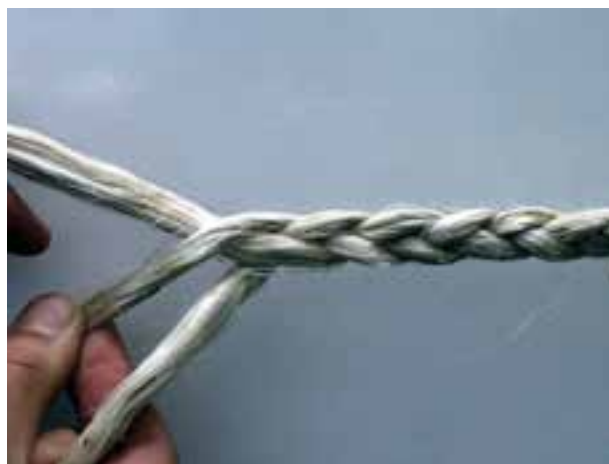
شکل ۲-۴- روش بافتن کنف به صورت سه رشته‌ای
