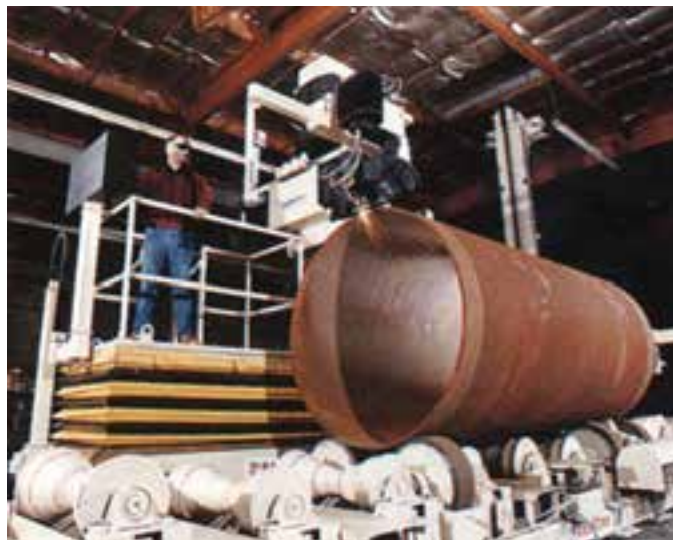
شکل ۷-۴۴- در این سیستم دستگاه ثابت است و لوله در زیر مشعل می چرخد.
