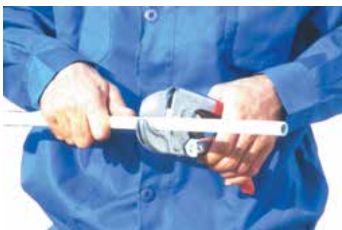
شکل ۲-۳- بریدن لوله با قیچی
