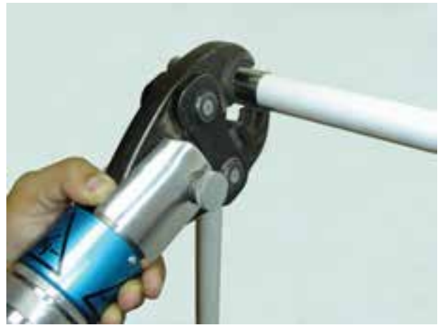
شکل ۱۱-۳- نحوه‌ی کار با دستگاه پرس
