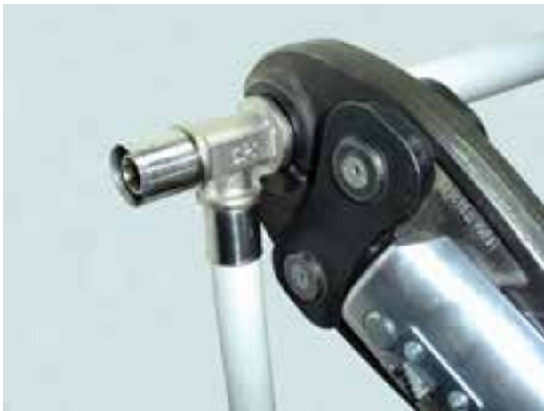
شکل ۱۱-۳- نحوه‌ی کار با دستگاه پرس
