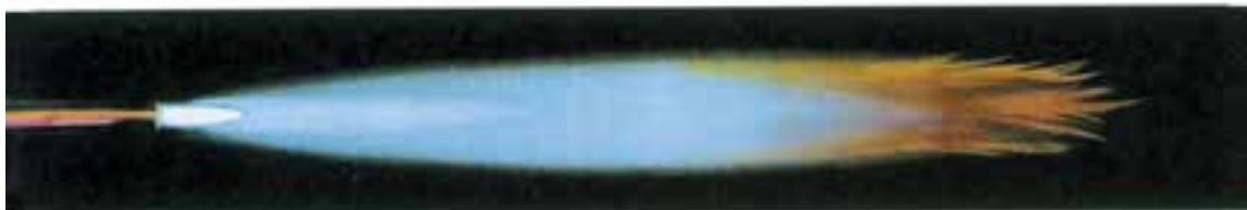
ب شعله احیاکننده (استیلن زیاد با اکسیژن) برای سختی سطحی و جوش فلزات سفید
