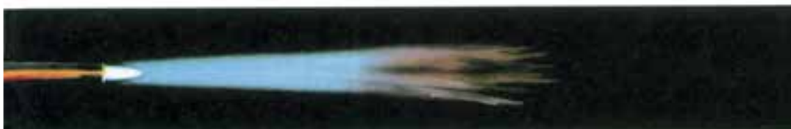
د شعله اکسید کننده (استیلن و اکسیژن زیاد) برای لحیم سخت با سیم جوش برنز شکل ۵-۳-رنگ و نمای شعله‌های اکسی استیلن
