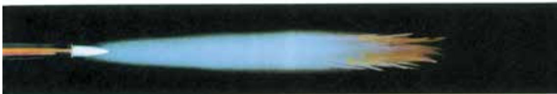
ج شعله خنثی (استیلن و اکسیژن) دما ۵۵۸۹ F (۳۰۸۷ C) برای جوش ذوبی فولاد و چدن
