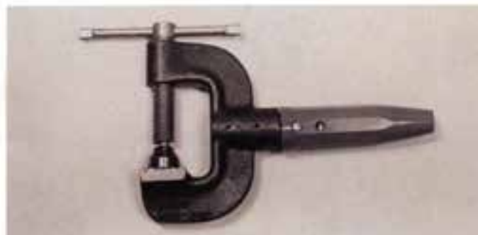
پ- گیره اتصال زمین از نوع AC برای کابل قطعه کار
