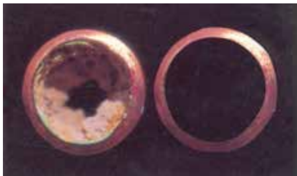
ب - لوله قبل و بعد از نصب سختی گیر
