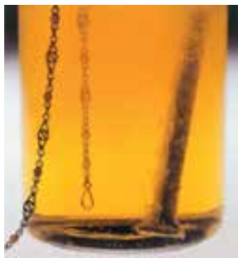
شکل ۴-۱- واکنش فلز روی (میخ شکل) با هیدروکلریک اسید و ایجاد گاز هیدروژن و واکنش نداشتن زنجیر طلا با هیدروکلریک اسید
