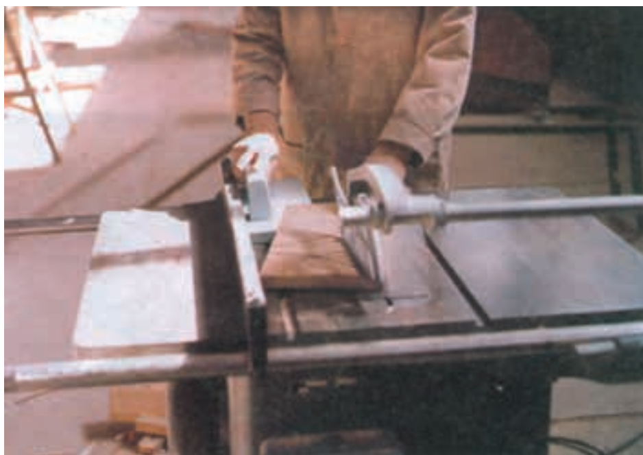
شکل ۱-۶۹- برش مورب تخته با استفاده از قالب هدایت چوبی آسان‌تر و بی‌خطرتر است.
