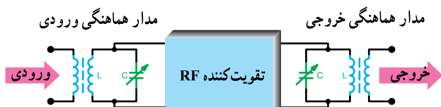
شکل ۴-۲- یک تقویت کننده رادیویی با مدار هماهنگی در ورودی و خروجی
