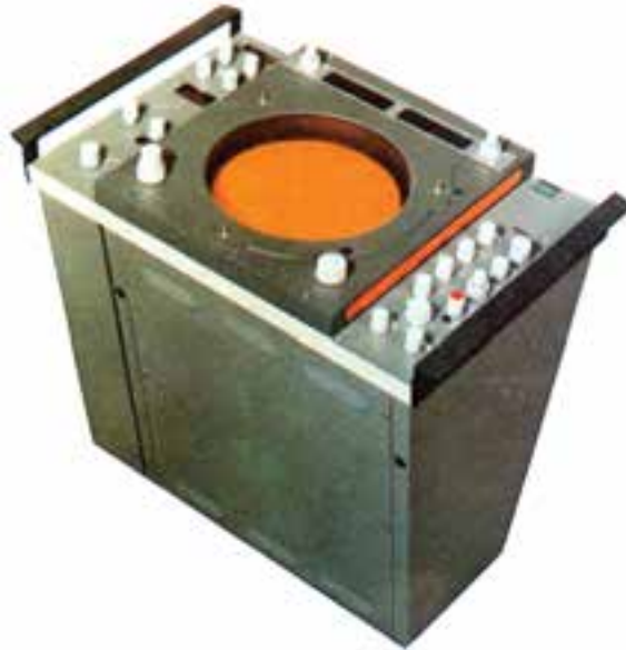
شکل ۲۱-۴- تصویری از یک کنسول رادار نوع ایستاده
