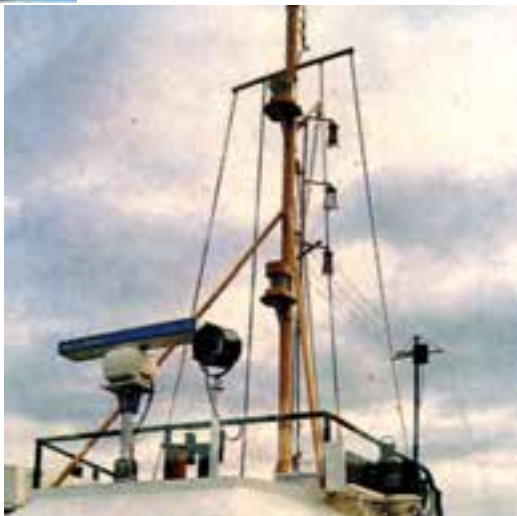
شکل ۴-۱۰ و ۴-۱۱- تصاویری از آنتن رادارهای ناوبری
