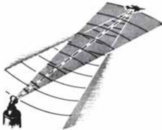
شکل ۱-۲- انتشار امواج رادیویی و بازتاب آن
