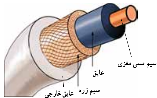
شکل ۷-۹ - اجزای تشکیل دهنده کابل کواکسیال
