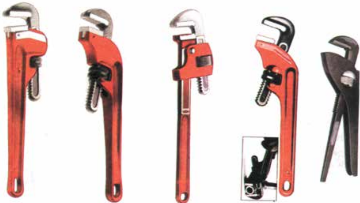
شکل ۱۸-۱ چند نوع آچار لوله‌گیر
