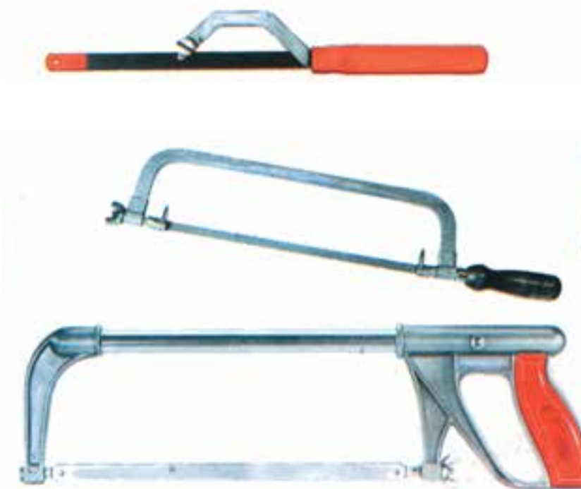
شکل ۱-۲- چند نمونه کمان اره آهن‌بر
