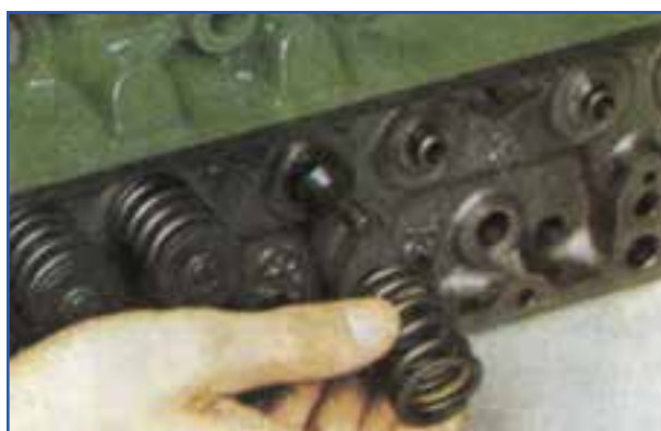
شکل ۴-۲۱- نحوه برداشتن فنر سوپاپ
