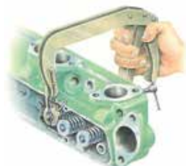
شکل ۴-۱۷- نحوه قرار دادن سوپاپ باز کن روی سوپاپ‌ها
