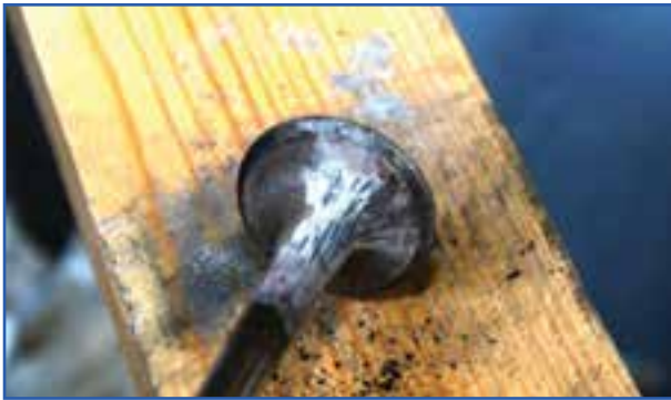
(ب) سوپاپ تمیز شده با کاردک
