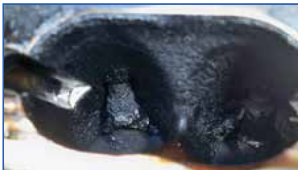
الف) کربن محفظه پشت سوپاپ‌ها
