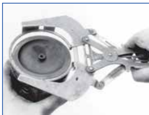
الف) طرز قرار گرفتن رینگ باز کن روی رینگ
