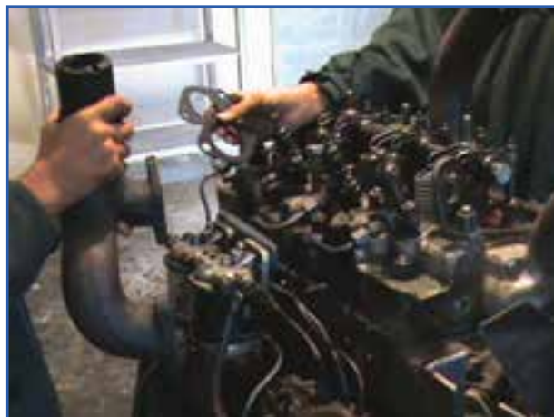
شکل ۴-۴- باز کردن مانیفولد هوا
