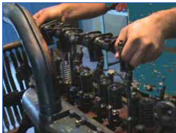
شکل ۹-۴ برداشتن محور اسبک و اسبک‌ها تراکتور U650
