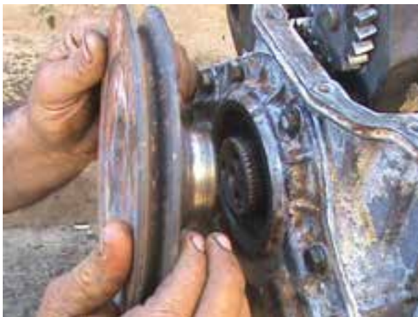
شکل ۴-۵۷- خارج کردن پولی میل لنگ
