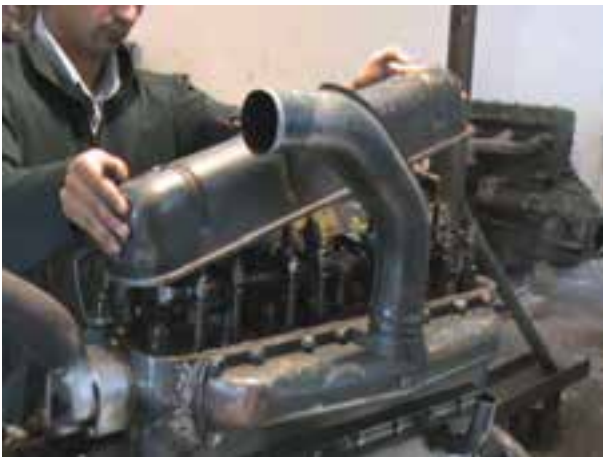
۱۰- پیچ‌های درپوش سوپاپ را باز کرده و آن را از دو انتها گرفته و بلند کنید، و اشر چوب‌پنبه‌ای مربوطه را بردارید.
