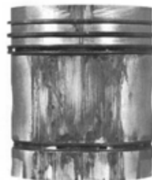
الف) خط و خش روی پیستون
