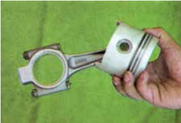
شکل ۱۲۶-۴ طرز آزمایش لقی شاتون روی انگشتی
