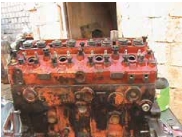
ب) پیچ‌های سرسیلندر باز شده تراکتور MF285
