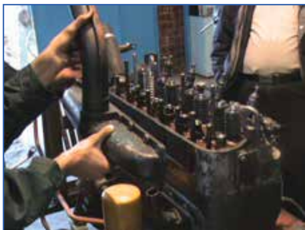
شکل ۴-۴- باز کردن مانیفولد هوا
