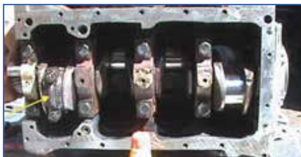
شکل ۸۳-۴- وضعیت میل‌لنگ برای باز کردن پیچ‌های شاتون
