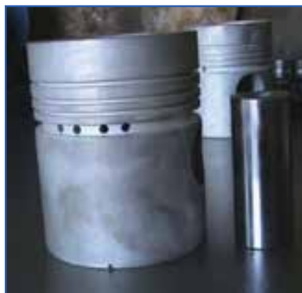
شکل ۱۰۷-۴ پیستون و انگشتی نو
