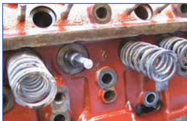
شکل ۴-۲۱- نحوه برداشتن فنر سوپاپ
