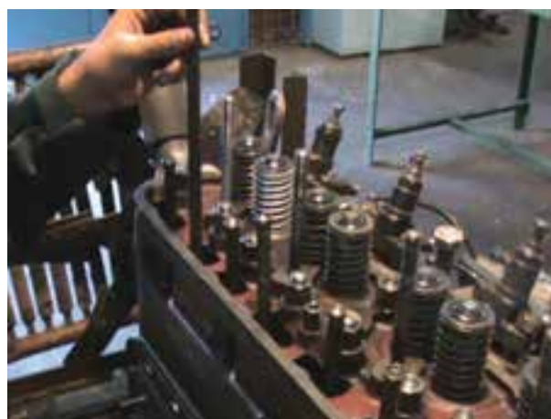
الف) برداشتن میل تایپت
