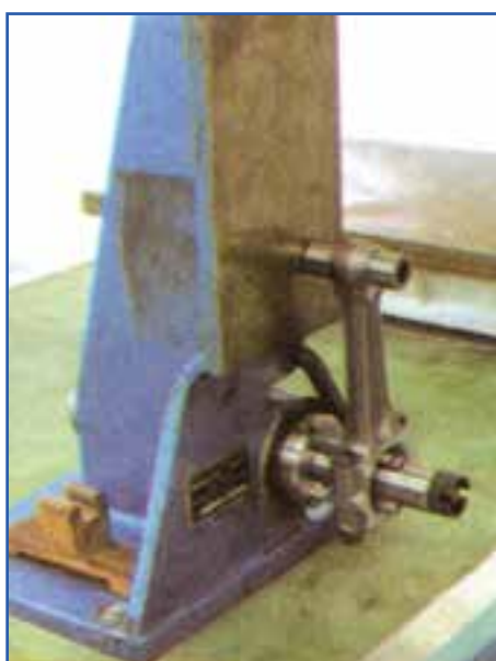
شکل ۴-۱۱۳- ساختمان و طرز نصب شاتون روی فیکسچر
