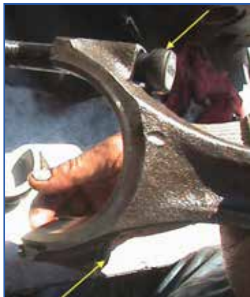
شکل ۸۵-۴- خارج کردن پیچ شاتون
