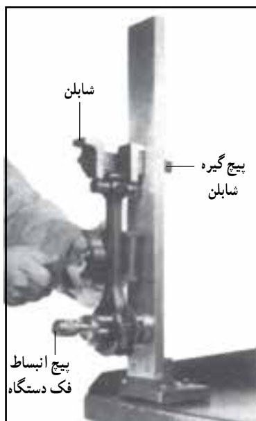
شکل ۴-۱۱۵- طرز صاف کردن شاتون خمیده
