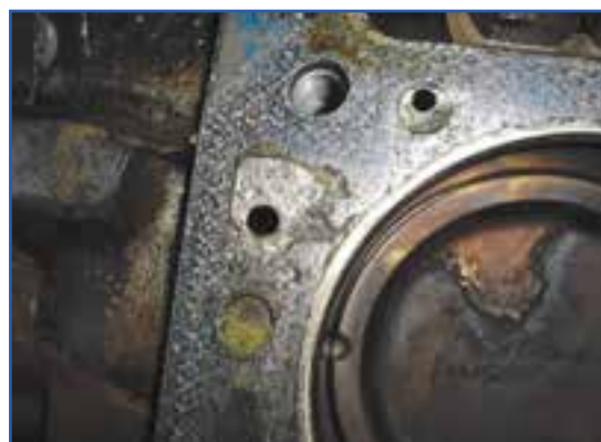
شکل ۴۲-۴- واشر سرسیلندر چسبیده به سیلندر
