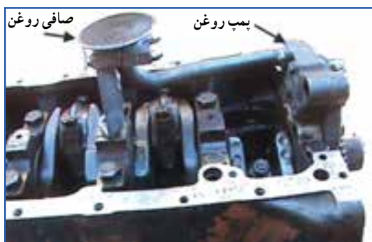
الف) محفظه میل‌لنگ بدون کارتر
