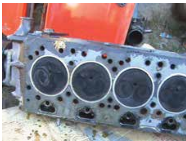
شکل ۱۵-۴ طرز قرار دادن سرسیلندر روی سطح صاف
