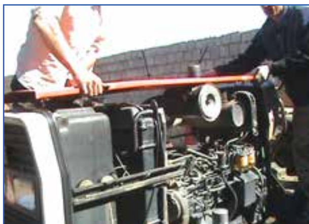
شکل ۱-۴- برداشتن کاپوت از روی موتور
