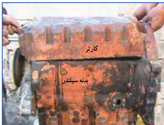
ب) برداشتن کارتر
