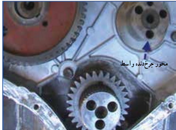
شکل ۶۷-۴ چرخ‌دنده واسط برداشته شده است.
