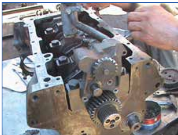
شکل ۷۸-۴- محل پیچ‌های پمپ روغن
