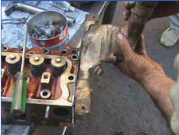
الف) باز کردن محفظه ترموستات تراکتور MF399
