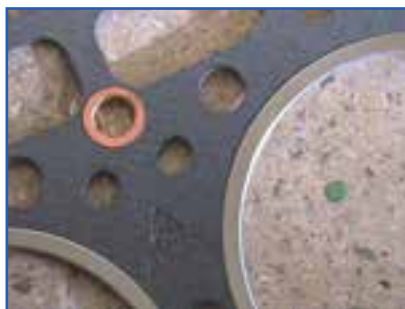
الف) سمت پهن نوار فلزی واشر سرسیلندر
