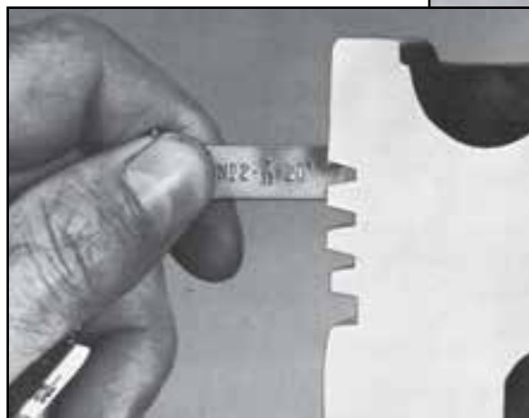
شکل ۹۳-۴ طرز اندازه‌گیری لقی رینگ در شیار رینگ‌ها با فیلر
