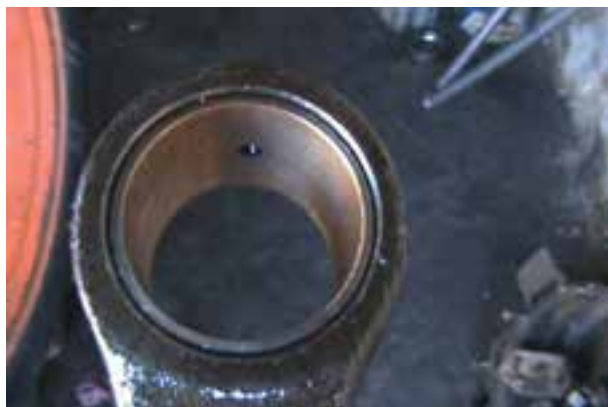
شکل ۱۲۰-۴ قرار گرفتن سوراخ بوش مقابل سوراخ شاتون
