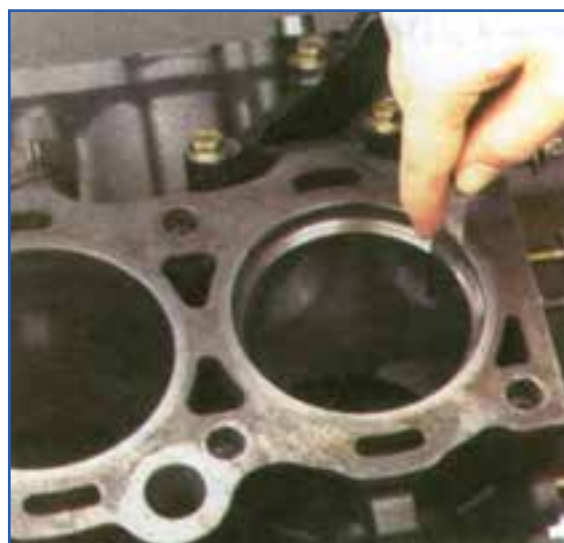
شکل ۱۲۸-۴ طرز اندازه گیری دهانه رینگ با فیلر
