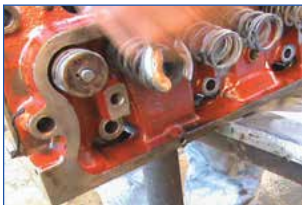
شکل ۴-۱۹- باز کردن اهرم فنر جمع کن
