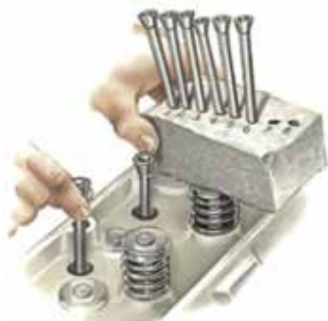
ب) به ترتیب قرار دادن میل تایپت
