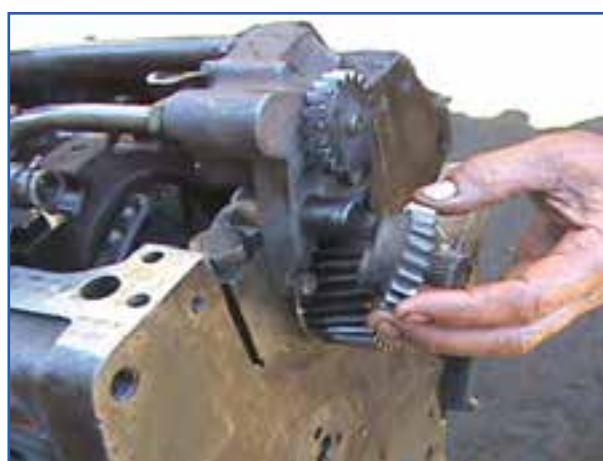
شکل ۸۰-۴- خارج کردن چرخ‌دنده پمپ روغن
