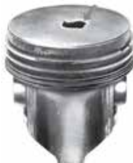
شکل ۴-۱۰۲- سوراخ شدن سر پیستون
