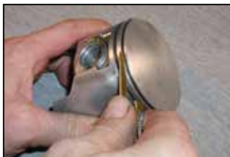
(د) تمیز کردن شیار با ابزار برنجی
