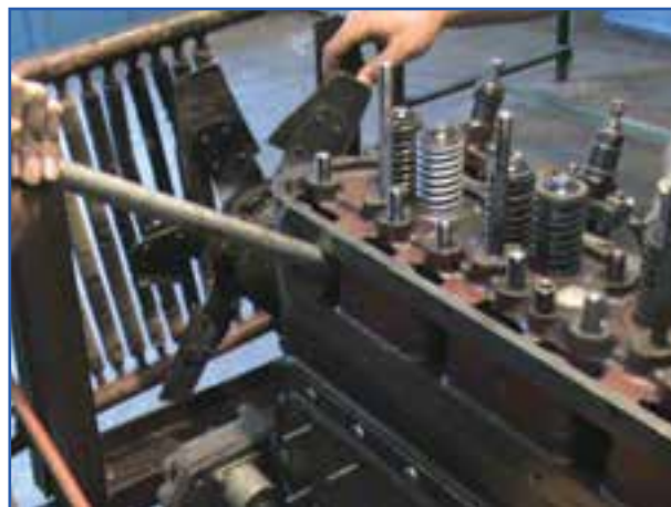
شکل ۱۳-۴ قرار دادن اهرم در مجرای دود
