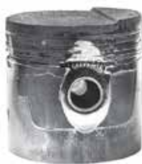
شکل ۴-۱۰۳- سایش غیریکنواخت پیستون
