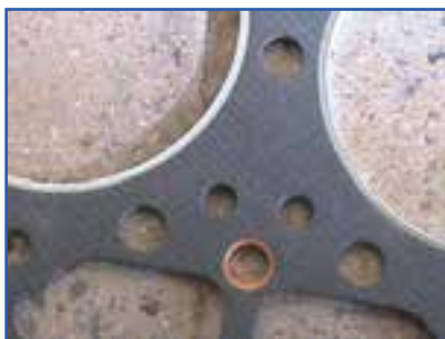
ب) سمت باریک نوار فلزی واشر سرسیلندر
