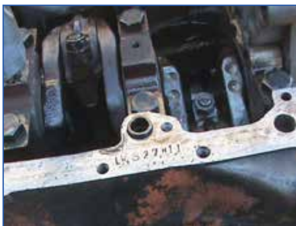
شکل ۸۲-۴- محفظه میل‌لنگ بدون پمپ روغن
