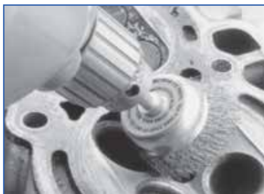
شکل ۴۱-۴- تمیز کردن اتاق احتراق
