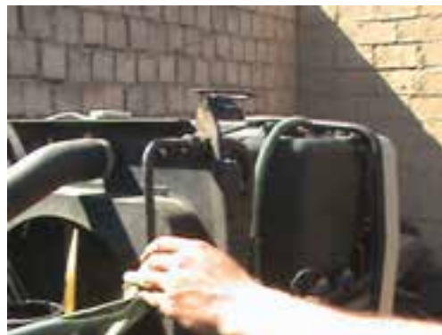
د) باز کردن لوله خنک کن روغن
