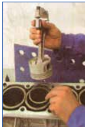
شکل ۱۲۷-۴ طرز قرار دادن رینگ داخل سیلندر
