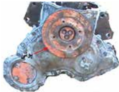
شکل ۴-۶۴ پولی نصب‌شده روی میل‌لنگ
