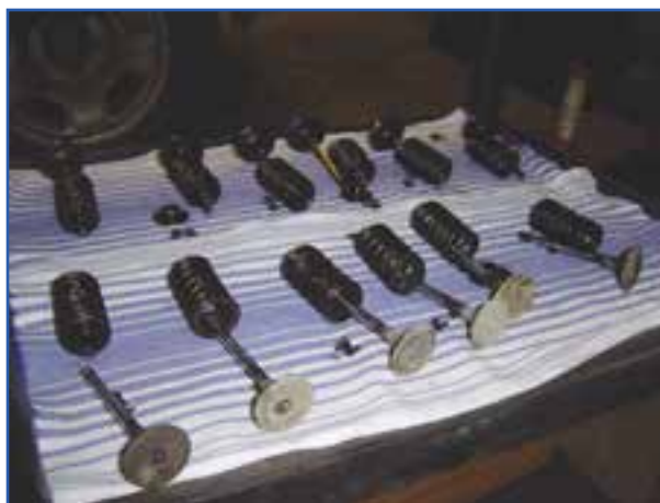
(الف) اجزای باز شده سوپاپ
