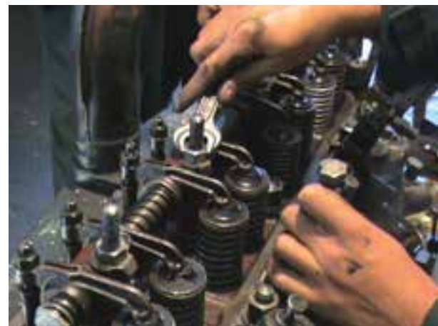
ب) باز کردن پایه محور اسبک MF399
