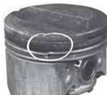
شکل ۴-۹۹- شکستن رینگ و تخریب جای رینگ
