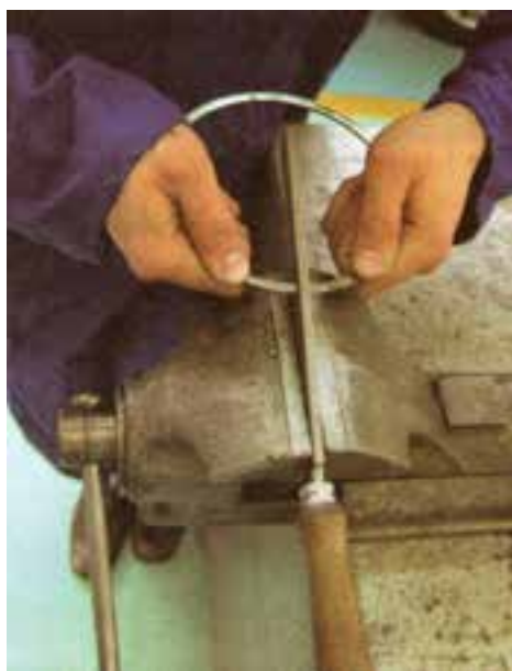
شکل ۱۳۰-۴ ساییدن دهانه رینگ با سوهان
