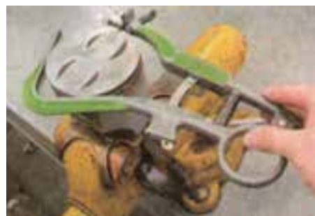
(ب) کاربرد ابزار تمیزکننده شیار رینگ‌ها
