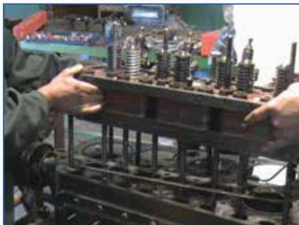
شکل ۱۴-۴ بلند کردن سرسیلندر از روی بدنه سیلندر
