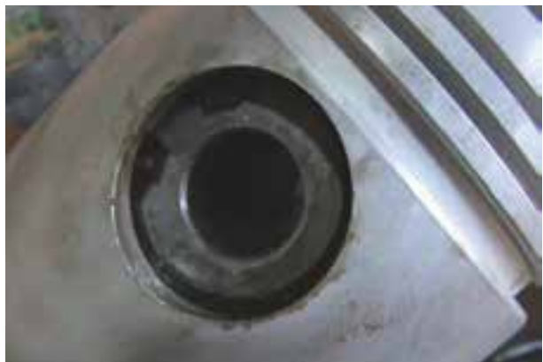
شکل ۱۲۵-۴ جا افتادن خار انگشتی در شیار پیستون
