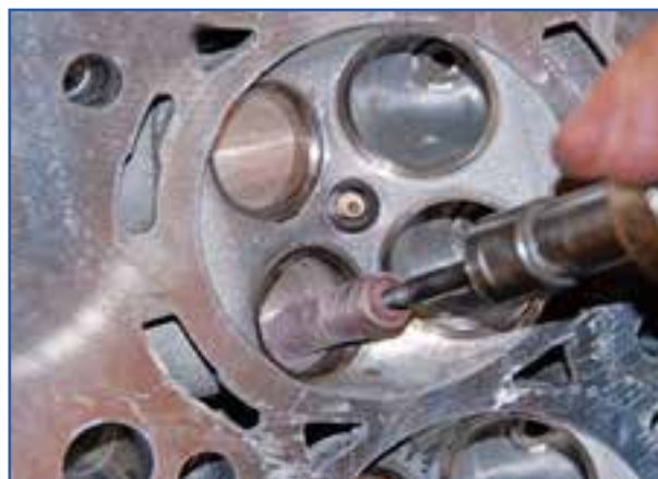
الف) نحوه تمیز کردن محفظه پشت سوپاپ
