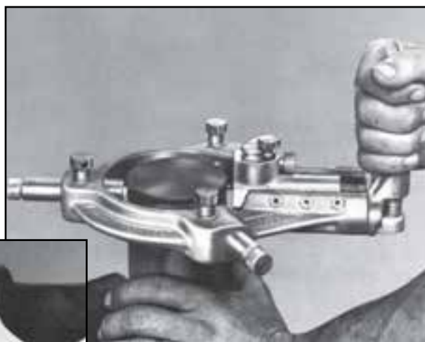
شکل ۹۴-۴ طرز تراش شیار رینگ
