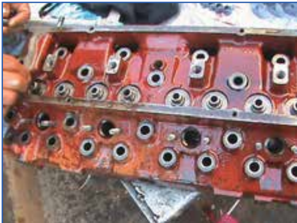
(ب) نحوه خارج کردن لاستیک آب بندي
