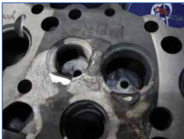
شکل ۲۶-۴- ترمیم ترک سرسیلندر با جوشکاری
