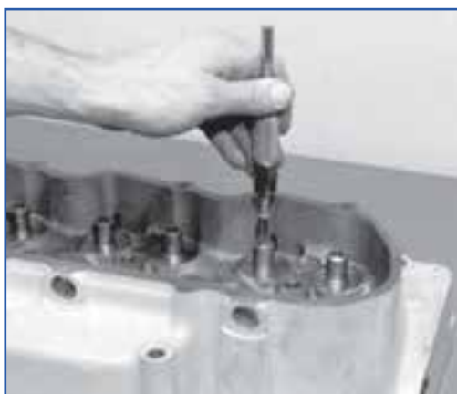
شکل ۴۰-۴- تمیز کردن گیت سوپاپ
