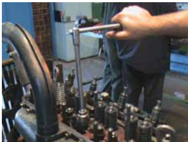
الف) باز کردن پیچ‌های سرسیلندر تراکتور U650
