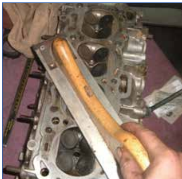
شکل ۴۴-۴- تمیز کردن سرسیلندر با سوهان نرم
