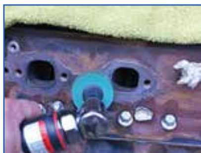
ج) نحوه تمیز کردن سطح مجاری خروج دود
