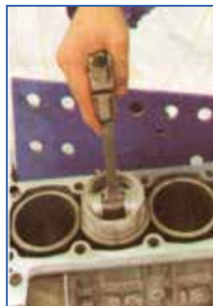
شکل ۱۲۷-۴ طرز قرار دادن رینگ داخل سیلندر
