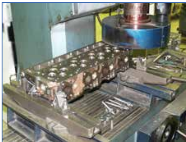
شکل ۳۲-۴- دستگاه کف تراشی سرسیلندر
