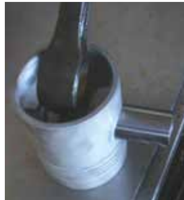
شکل ۱۲۲-۴ اتصال شاتون به پیستون و جازدن انگشتی
