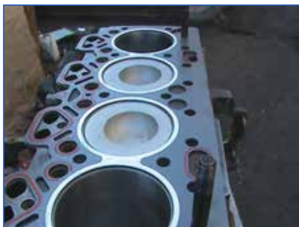
شکل ۵۲-۴- قرار دادن واشر سرسیلندر روی بدنه سیلندر
