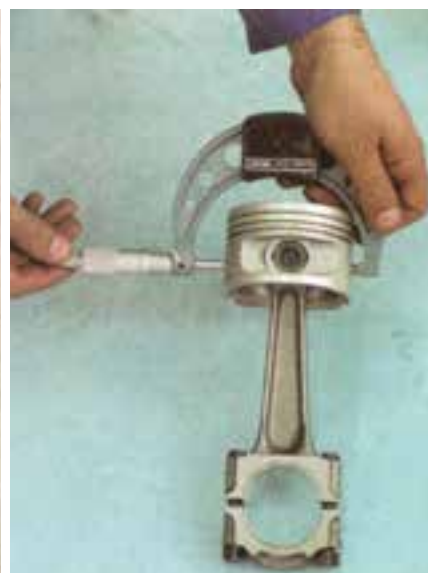
(الف) اندازه گیری قطر دامن پیستون
