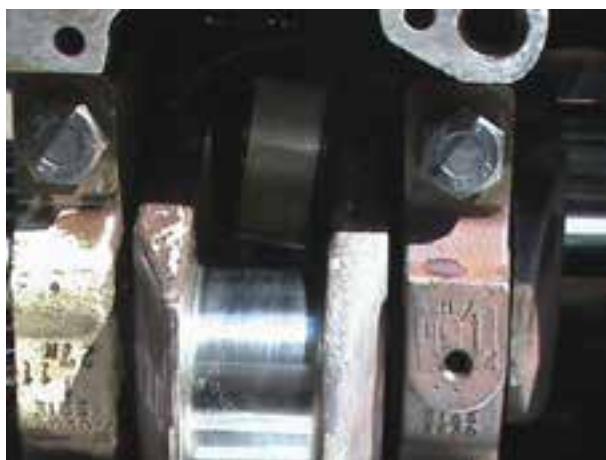
شکل ۸۸-۴ شاتون در حال خارج شدن
