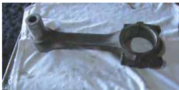
شکل ۱۲۱-۴ امتحان کردن انگشتی روی شاتون
