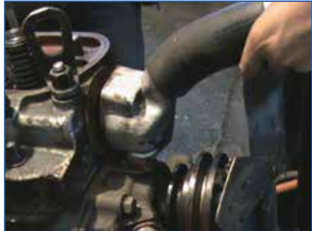
ب) باز کردن محفظه ترموستات تراکتور U650
