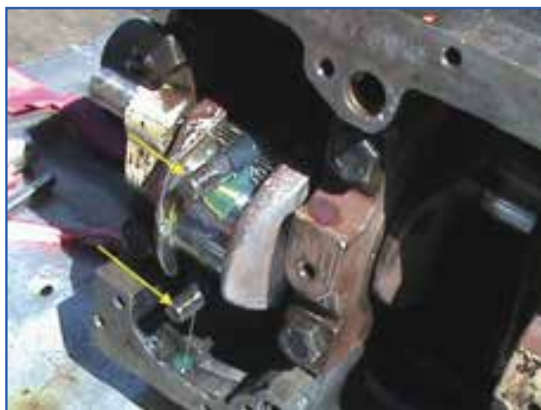
شکل ۸۴-۴- کپه یاتاقان باز شده
