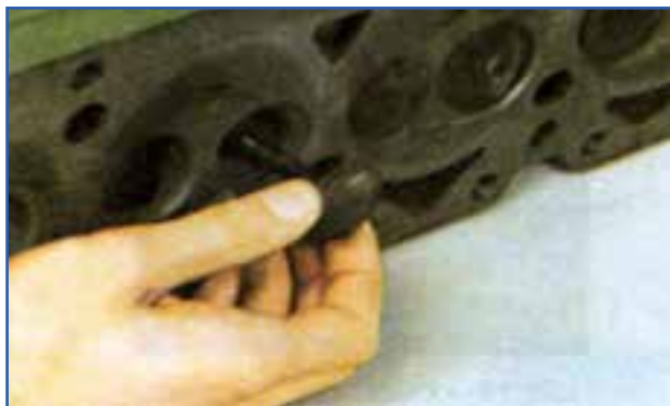
شكل ۲۳-۴- نحوه خارج کردن سوپاپ‌ها
