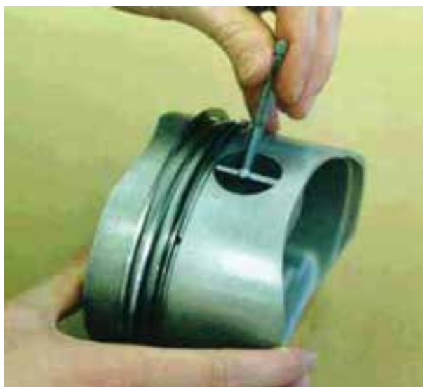
شکل ۱۱۷-۴ اندازه‌گیری سوراخ انگشتی روی پیستون
