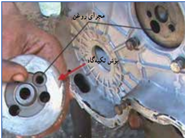
شکل ۶۸-۴ خارج کردن بوش تکیه‌گاه چرخ‌دنده واسط
