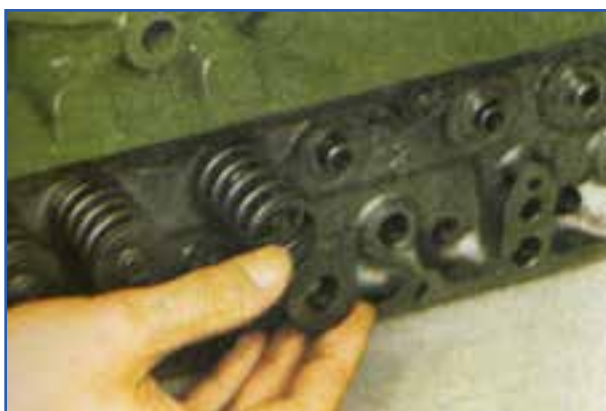
شکل ۴-۲۰- نحوه برداشتن بشقابک فنر سوپاپ
