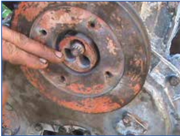
شکل ۴-۵۵- بستن پیچ سر میل لنگ تراکتور
