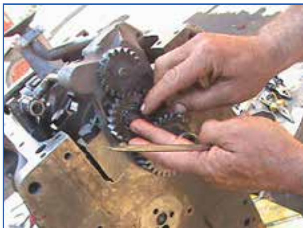
شکل ۷۹-۴- خارج کردن چرخ‌دنده پمپ روغن
