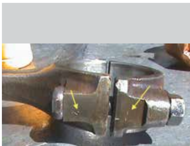
شکل ۸۷-۴ علامت روی کپه شاتون و شاتون
