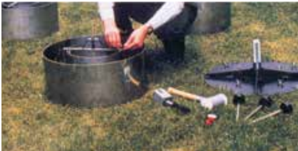
شکل ۳۰-۱ نحوه کار گذاشتن استوانه مضاعف
