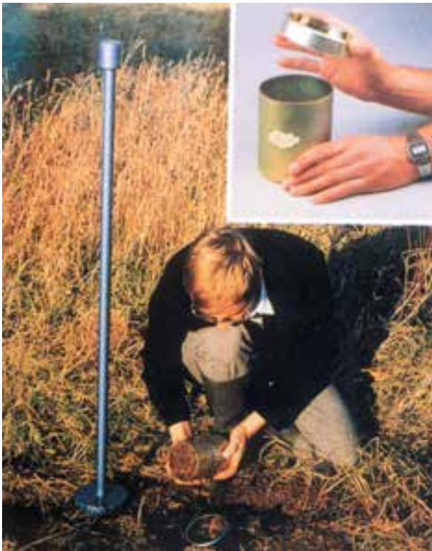
شکل ۱۶- ۱ نمونه برداری از خاک با سیلندر
