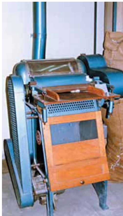
شکل ۱۸-۱-ب - دستگاه اندازه گیری خلوص الیاف پنبه
