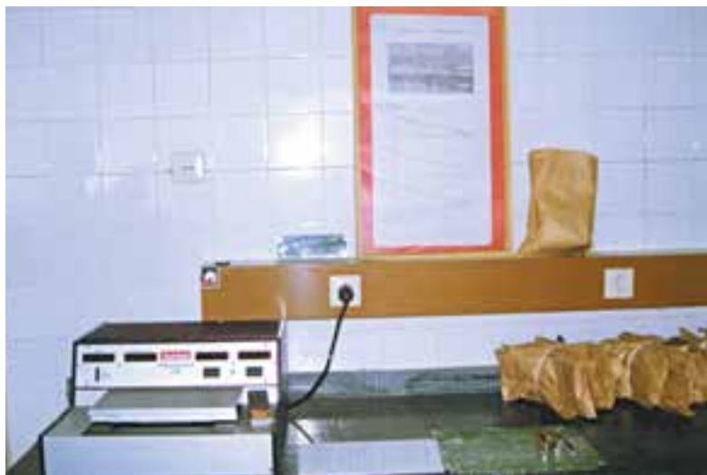
شکل ۱۹-۱- دستگاه اندازه گیری طول و یکنواختی الیاف پنبه
