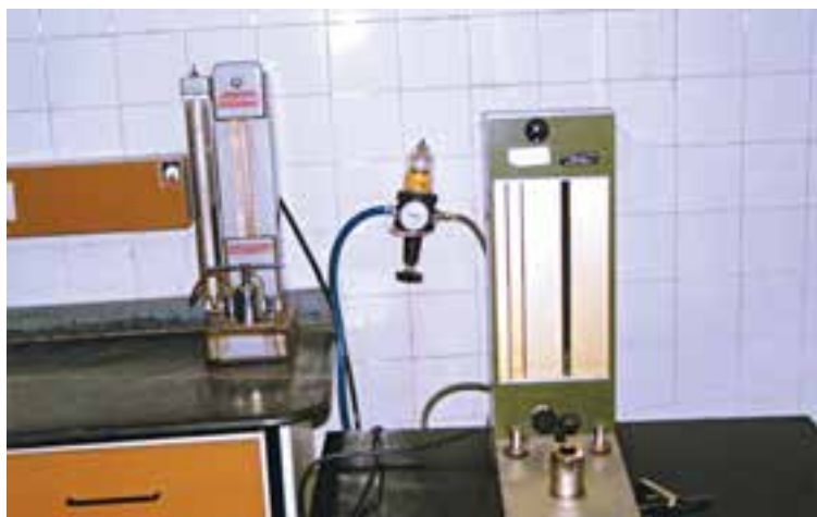
شکل ۱۸-۱ الف - دستگاه اندازه‌گیری ظرافت الیاف پنبه
