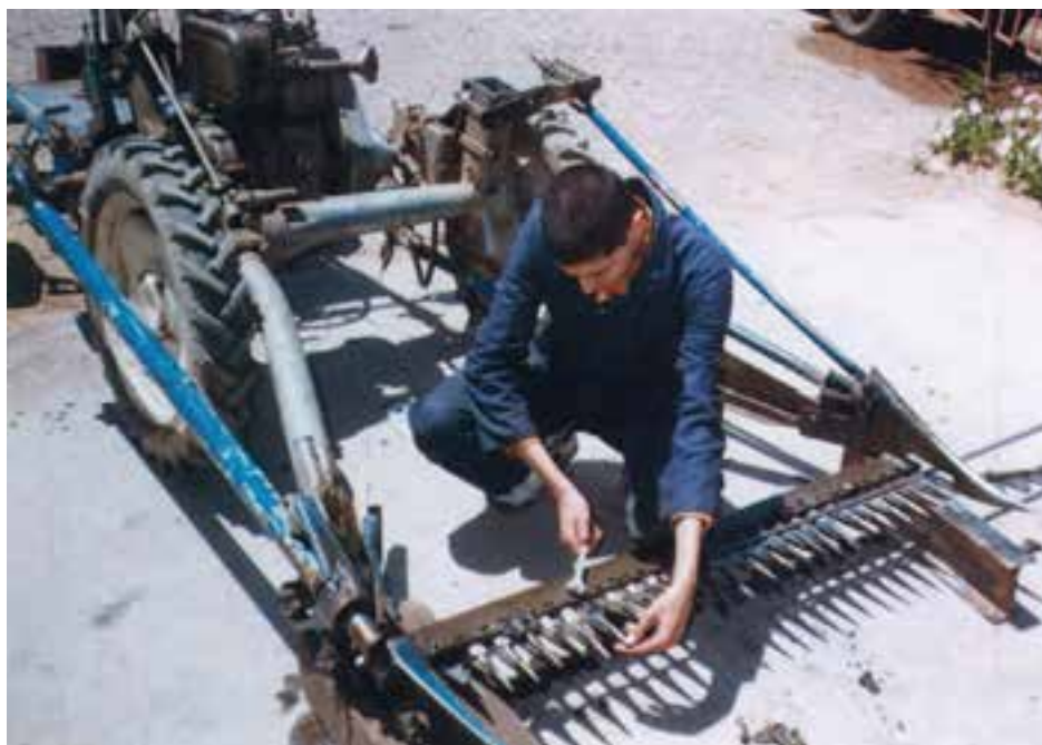
شکل ۱۴-۳- باز کردن انگشتی‌ها
