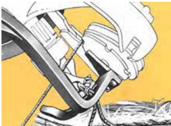
شکل ۶-۳- گره تشکیل شده، بیرون می‌افتد.
