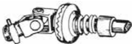
ب - کلاچ در حالت انتقال نیرو
