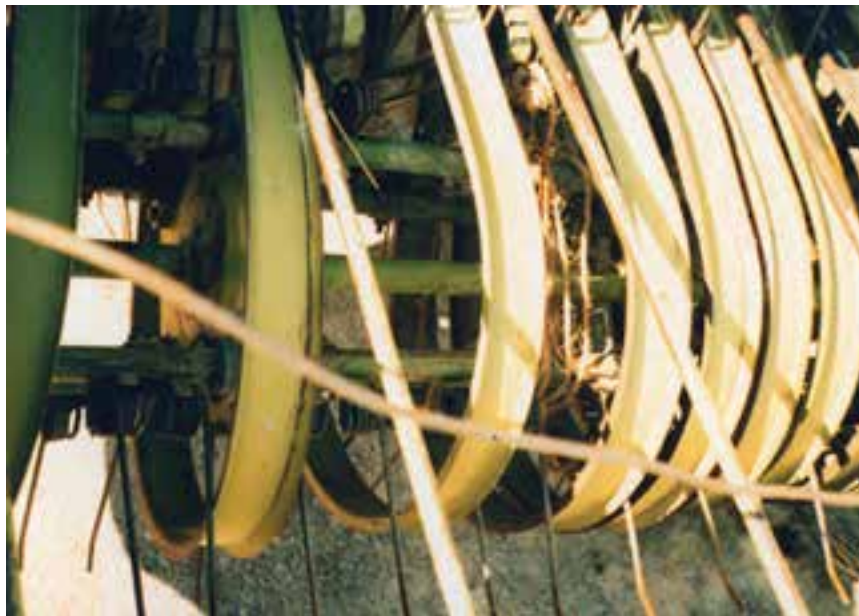
شکل ۲۹-۱- محور انگشتی کج شده
