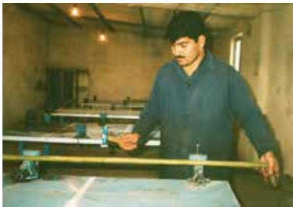
شکل ۲۴-۱ فردی در حین صاف کردن محور انگشتی‌ها
