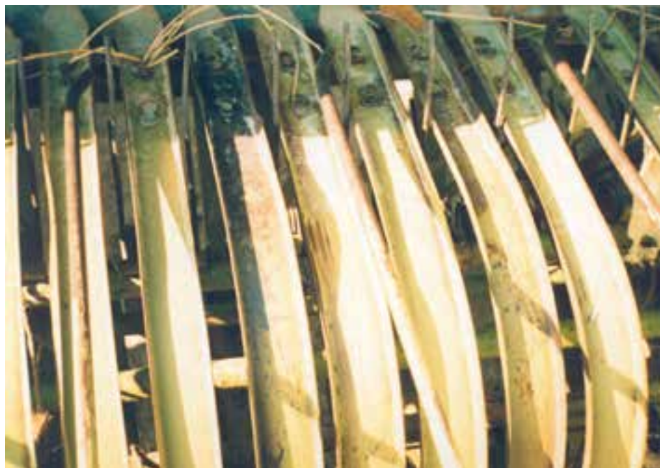
شکل ۱۹-۱- ساییده شدن انگشتی‌ها به طوقه‌ها
