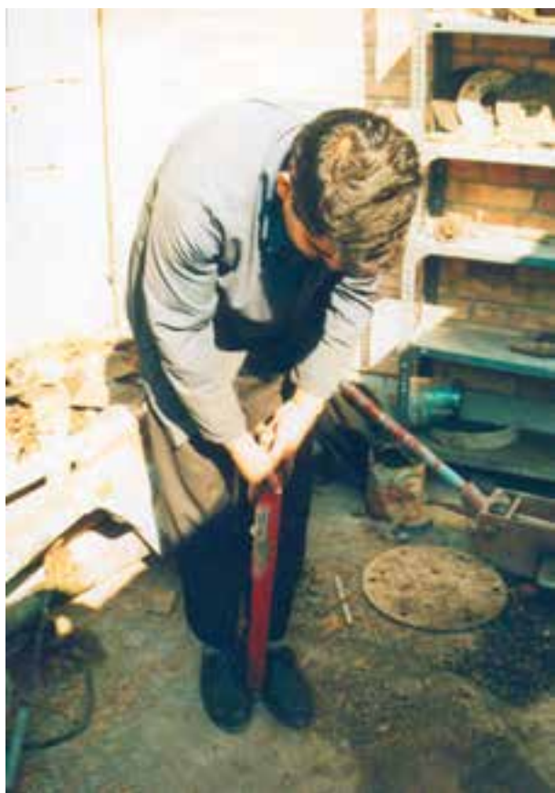
شکل ۳۸-۱- آزمایش کمک فنر
