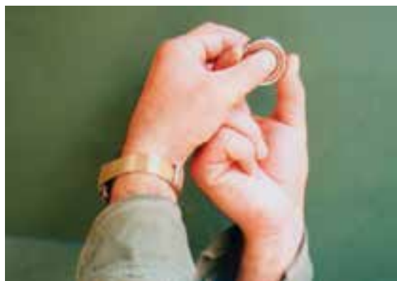
شکل ۲۵-۱ طرز آزمایش بلبرینگ لق بین انگشتان
