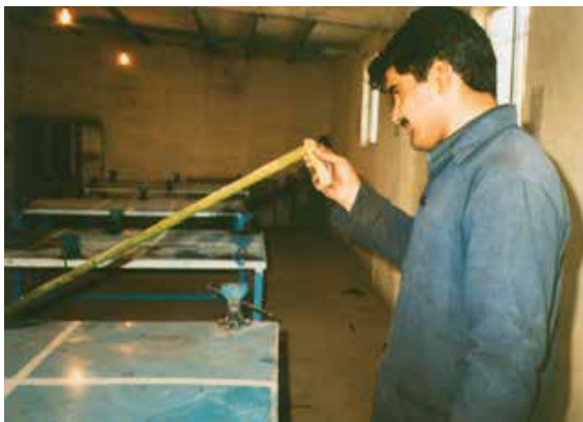
شکل ۲۳-۱- فردی در حال آزمایش کجی محور انگشتی‌ها
