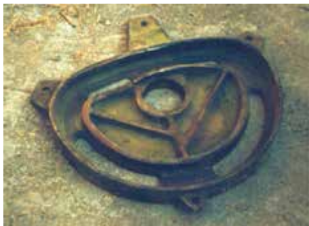
شکل ۲۷-۱- محفظه ( بادامک راه) ساییده شده
