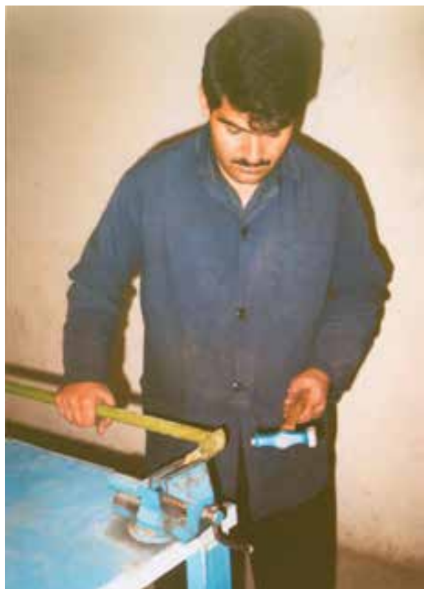
شکل ۲۸-۱- حین صاف کردن پایه بلبرینگ‌ها یا چکشی
