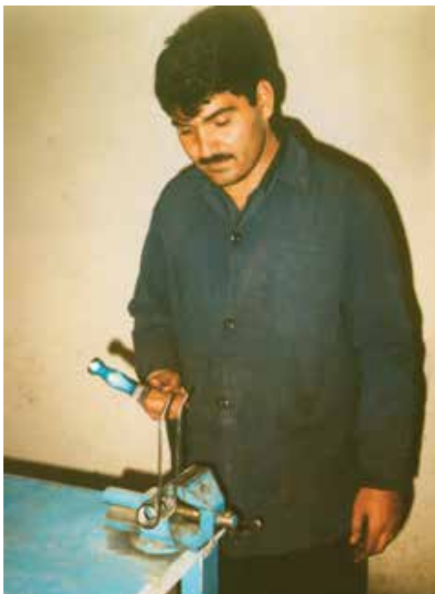
شکل ۱-۲۰- قرار دادن انگشتی‌ها مابین گیره و صاف کردن با چکشی
