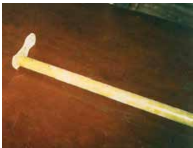
شکل ۲۶-۱ پایه کج شده بلبرینگ انگشتی
