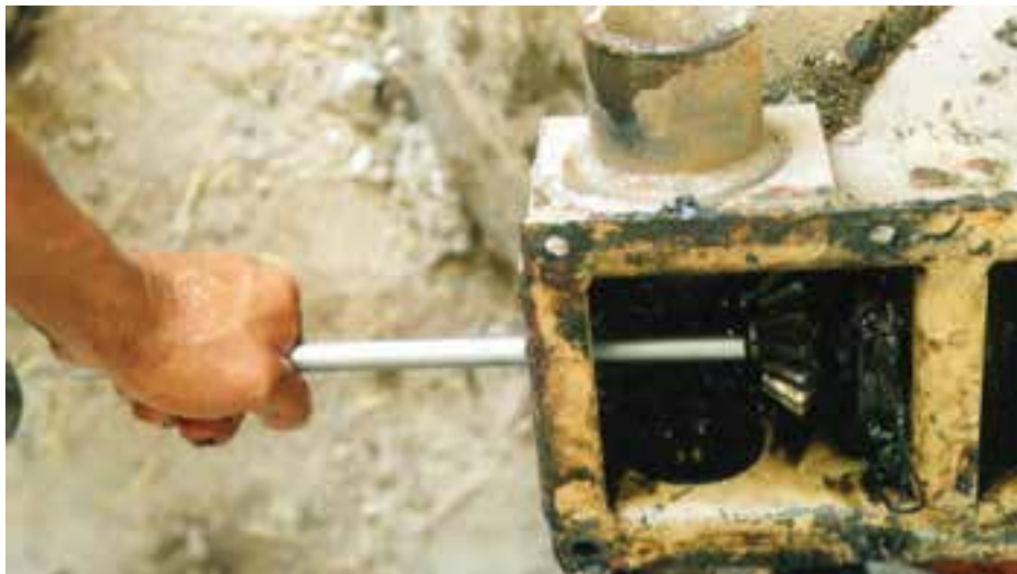
شکل ۹-۷- ضربه از طرف درپوش ۱۱ توسط میله برنجی
