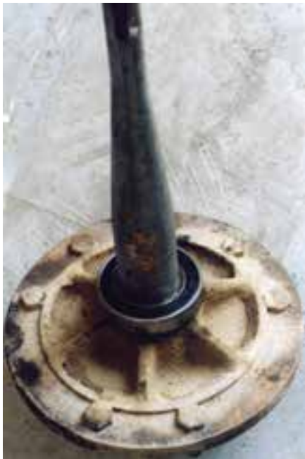
شکل ۸-۱۰ - محور استوانه و تویی آن
