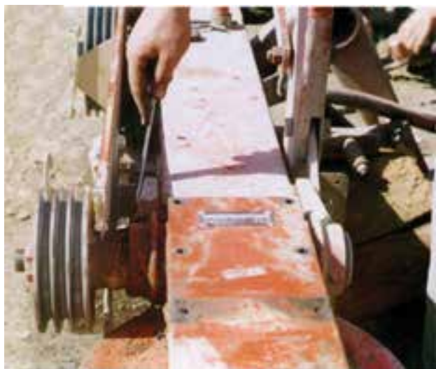
شکل ۱۰-۶ - باز کردن پیچ‌های لولا
