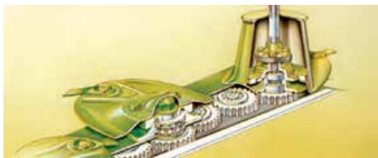
شکل ۴-۱۰ - جعبه دنده زیر بشقاب‌ها
