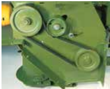
الف - انتقال قدرت با تسمه
