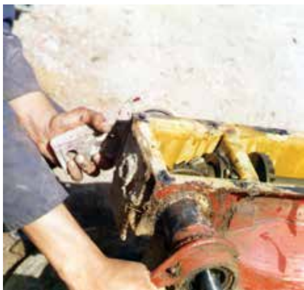
شکل ۱۱-۶ - خارج کردن لولاها
