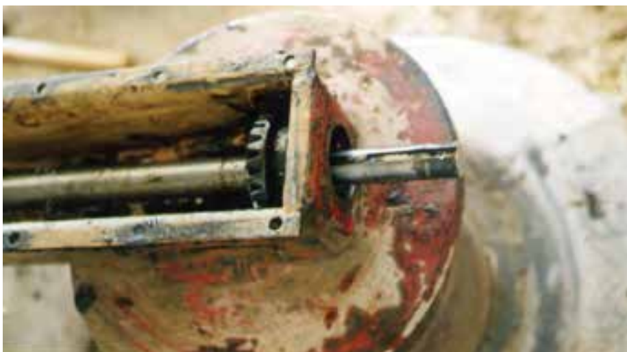
شکل ۱۰-۷- خارج کردن محور افقی از محل درپوش ۴
