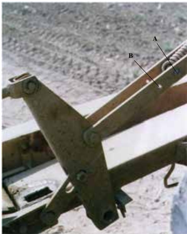
شکل ۲-۱۱- فتر شناور و محل تنظیم آن A - کشش کم B - کشش زیاد
