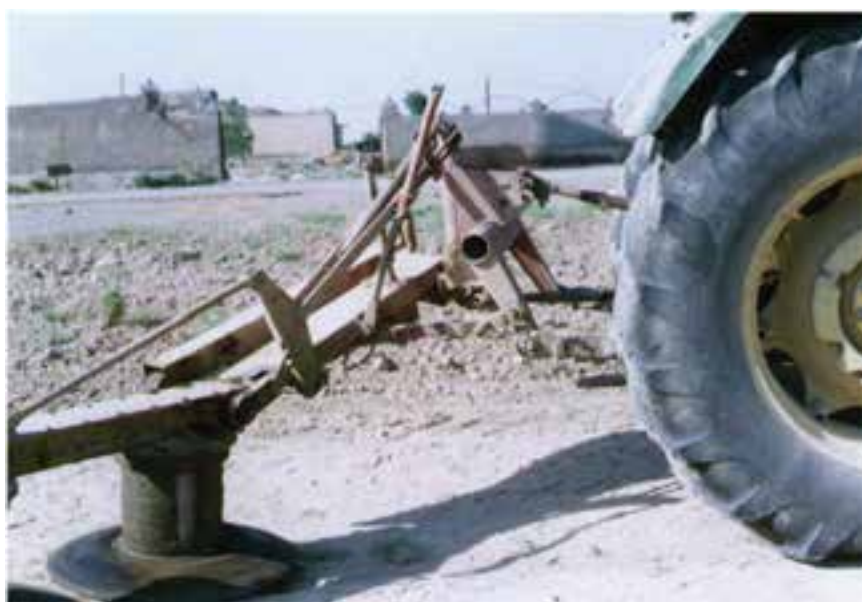
شکل ۱۵-۲ عقب کشیده شدن دروگر پس از آزاد شدن ضامن ایمنی
