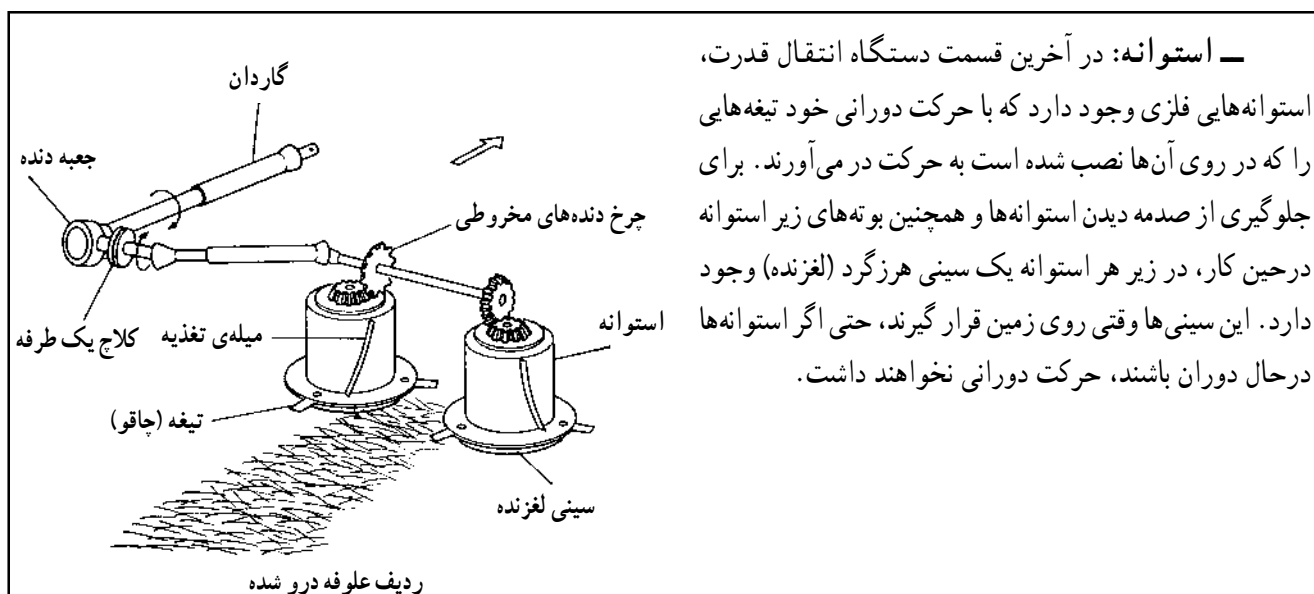
شکل ۱۴-۱- ترتیب انتقال حرکت در یک دروگر استوانه‌ای
