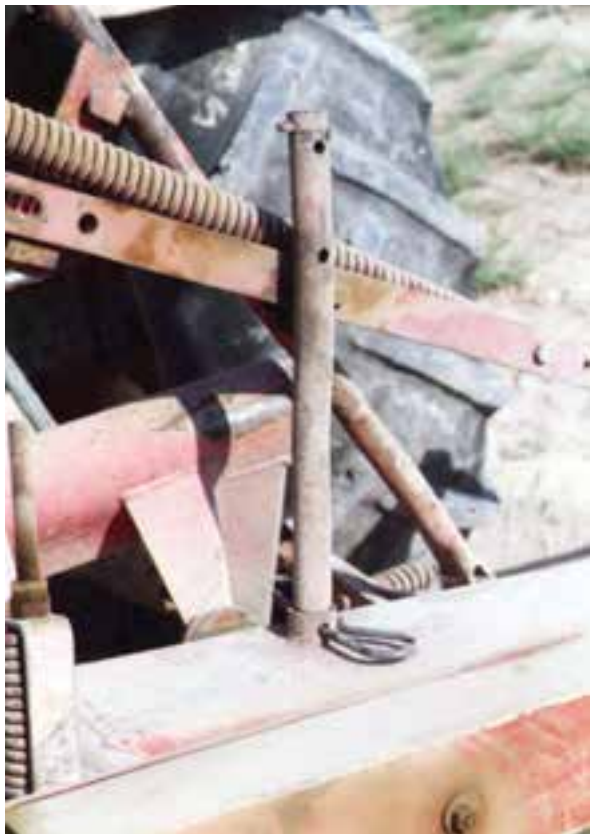
شکل ۵-۲- پایه‌ی نگه‌دارنده در حالت حمل و نقل
