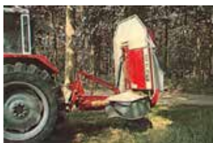
ج - تغییر وضعیت حمل و نقل به صورت هیدرولیکی شکل ۲-۶
