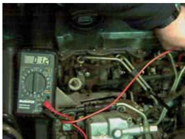
شکل ۱۳-۲۳ اندازه‌گیری مقاومت شمع گرم‌کن سیلندر چهارم
