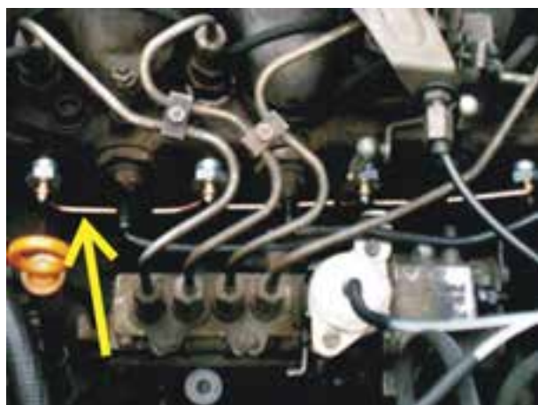
شکل ۷-۱۳- اتصال سری شمع گرم کن
